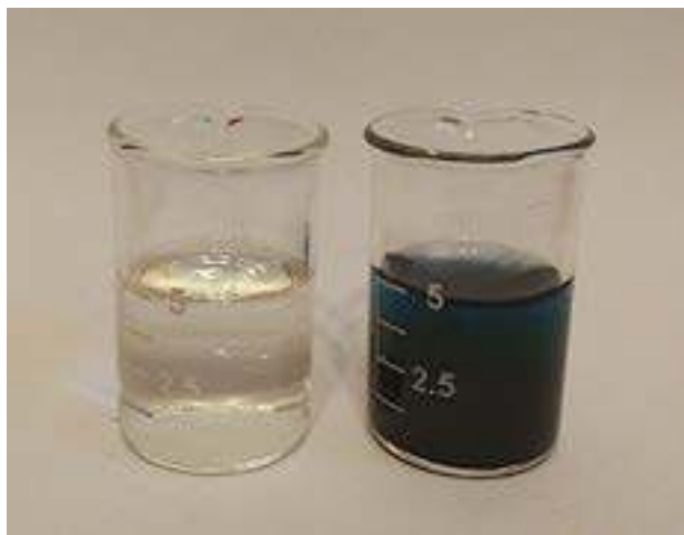
Fot. 15 – Wykrywanie nadtlenu wodoru za pomocą zakwaszonego roztworu jodku z dodatkiem skrobi ziemniaczanej; po lewej – przed dodaniem nadtlenu, po prawej – dodatni wynik próby
