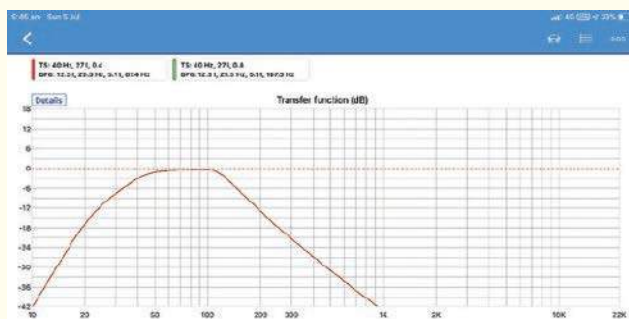
Rysunek 14. Przewidywana odpowiedź subwoofera w wersji „Bass Barrel” jest bardzo zbliżona do wersji prostokątnej
