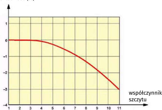
Rysunek 7. Dokładność AD536A jako funkcja współczynnika szczytu (© 2020 Jos Verstraten)
