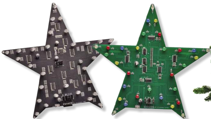
Rysunek 1. Dwie wersje naszej Gwiazdy Bożonarodzeniowej: po lewej (czarna płytka drukowana) to bardziej skomplikowana Gwiazda LED RGB (tutaj pokazana bez zasilania), podczas gdy po prawej (zielona płytka drukowana) to podstawowa Gwiazda LED z ekspozycją czasową umożliwiającą zaświecenie większości diod LED
