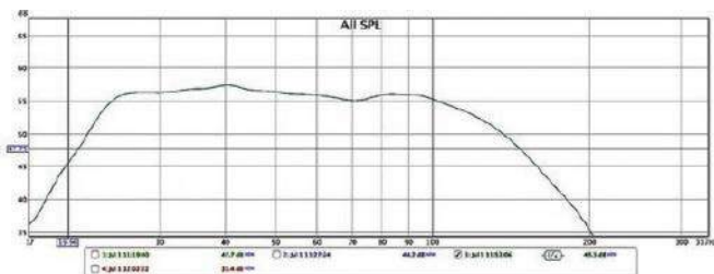
Rysunek 5. Potencjalnie możliwa charakterystyka tego subwoofera po zastosowaniu korekcji (patrz opis). Jest teraz w większości płaska od 24 Hz do nieco ponad 100 Hz. To doskonały wynik dla tak małej kolumny!
