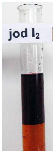
7. Jod przechodzi z roztworu wodnego (dolna warstwa) do rozpuszczalnika organicznego (górna warstwa).
