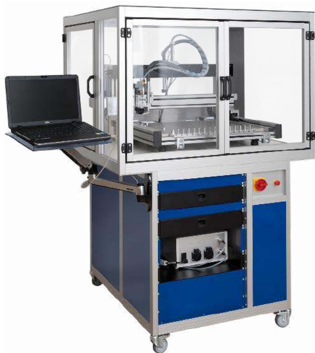
Fotografia 30. Precyzyjna frezarka CNC – model CCD Premium marki Bungard ( https://t.ly/cyA3l )
