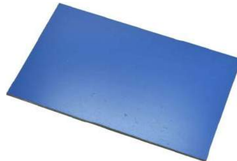
Fotografia 22. Formatka laminatu światłoczułego, pokryta folią ochronną ( https://t.ly/9Vxpu )
