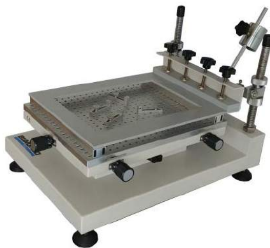
Fotografia 44. Manualna drukarka pasty lutowniczej – model PRINTSTAR 3000 ( https://t.ly/h9NE1 )
