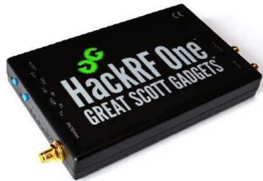
Fotografia 14. Urządzenie HackRF One (https://t.ly/2BKTW)
