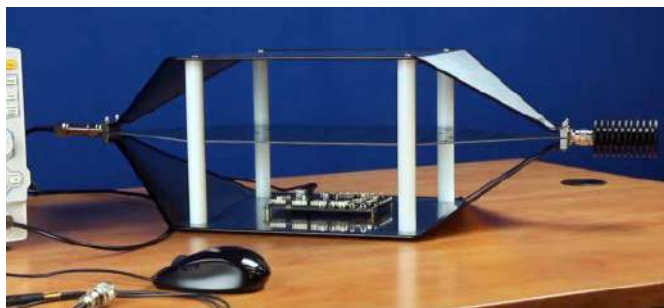
Fotografia 18. Niewielka komora TEM do badań precompliance ( https://t.ly/g6Glj )
