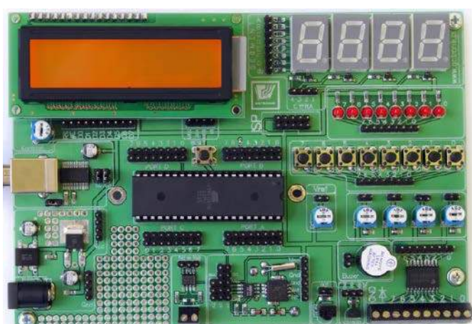
Fotografia 10. Płyta ewaluacyjna do mikrokontrolerów ATmega16 marki Gotronik ( https://t.ly/Z2g37 )
