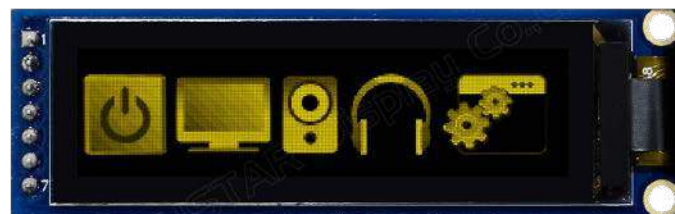
Fotografia 6. Wyświetlacz graficzny OLED typu WEA025664ALAP3N z serii Longlife firmy Winstar o bardzo wysokim kontraście
