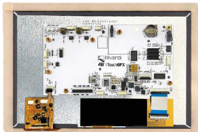
Fotografia 3. Wyświetlacz STM32 Embedded RVT101HVSNWC00-B polskiej firmy Riverdi, który umożliwia łatwe projektowanie interfejsów graficznych
