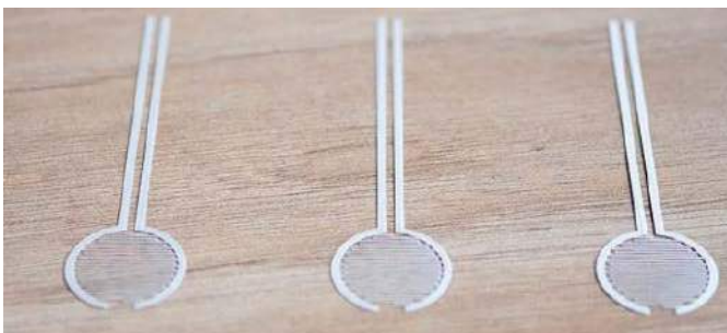
Fotografia 37. Foliowe czujniki nacisku, wydrukowane na folii PET za pomocą drukarki NOVA ( https://t.ly/dlnj9 )
