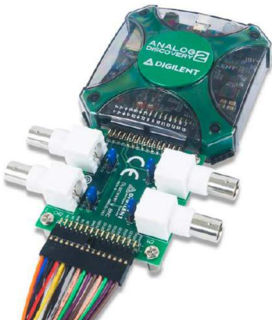
Fotografia 13. Zestaw Analog Discovery marki Digilent z podłączonym adapterem I/O (https://t.ly/Nvv3n)
