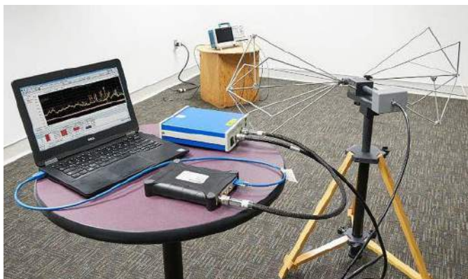
Fotografia 16. Zestaw do badań precompliance, w konfiguracji do badania emisji EMC – analizator widma w postaci przystawki komputerowej współpracuje z anteną, wycelowaną w badane urządzenie, oddalone na odległość 3 metrów ( https://t.ly/iCnNq )
