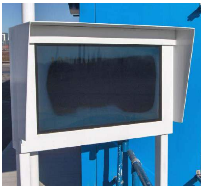
Fotografia 7. Ekran LCD uszkodzony na skutek długotrwałego oddziaływania intensywnego oświetlenia słonecznego
