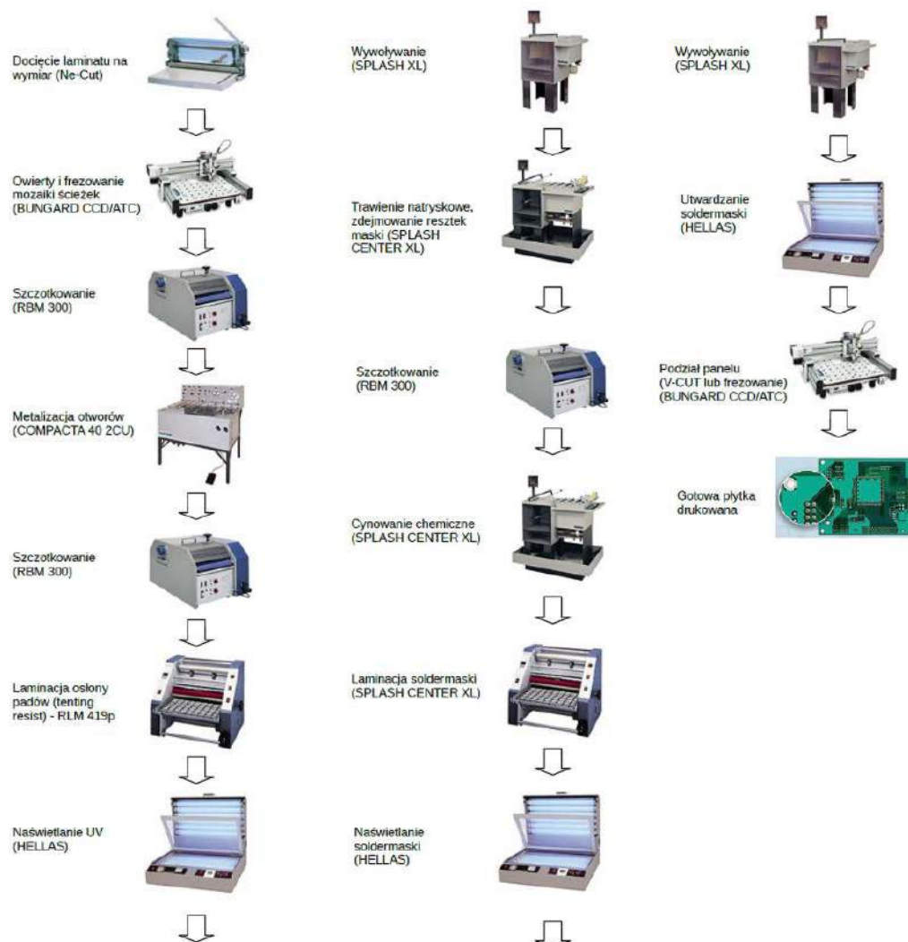
Rysunek 14. Proces ekspresowej produkcji płytek drukowanych z użyciem sprzętu marki Bungard (na podstawie: https://t.ly/fsjM0 )
