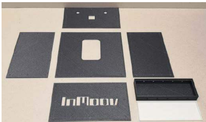
Fotografia 3. Zewnętrzne części obudowy stojaka
