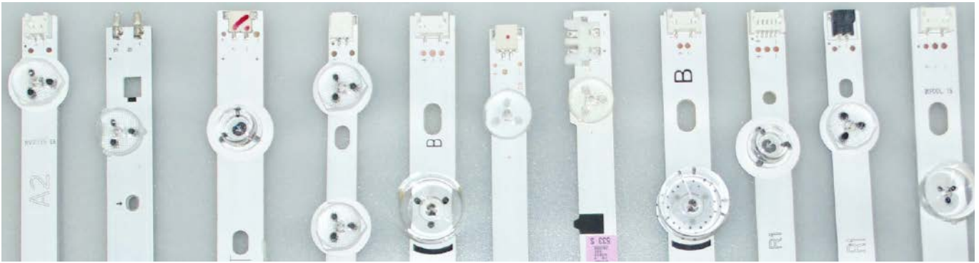
Fotografia 5. Przykłady specjalnych diod LED z soczewkami do podświetlania direct LED
