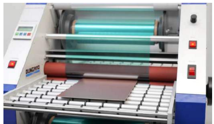
Fotografia 24. Proces pokrywania laminatu folią światłoczułą przy użyciu laminatora RLM 419p marki Bungard ( https://t.ly/oqpvH )
