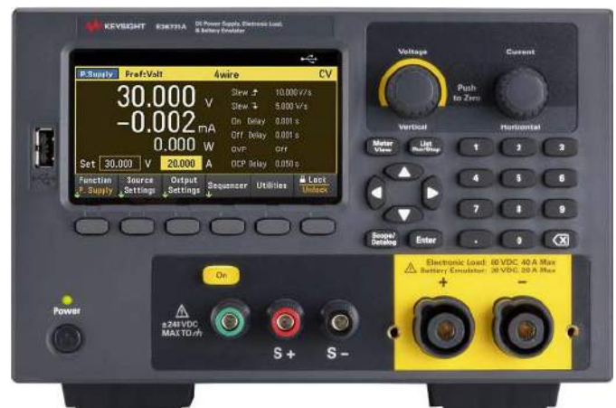
Fotografia 3. Emulator baterii i akumulatorów – Keysight E36731A ( https://t.ly/fgEL5 )
