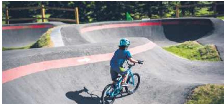
Pumtrack to zazwyczaj asfaltowy, kręty tor z przeszkodami, muldami, zjazdami i rampami do jazdy na rowerze, rolkach, deskorolce czy hulajnodze.
