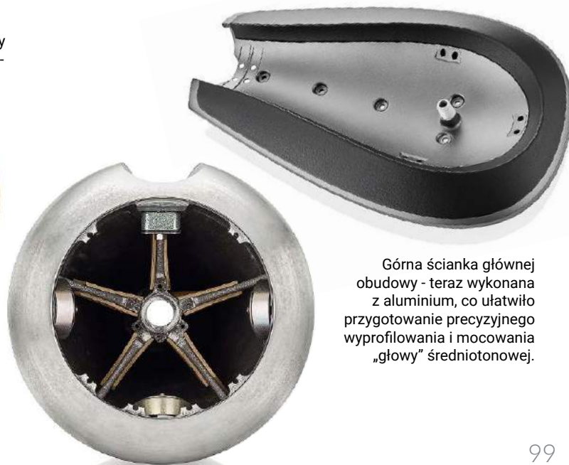
Głośnik średnionowy mocowany jest za pomocą pojedynczego pręta i za pośrednictwem podkładek tłumiących drgania.
