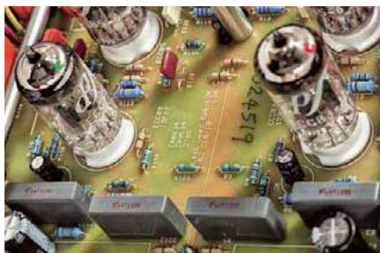
Pracujące w przedwzmacniaczu ECC83 zainstalowano w podstawkach wewnątrz obudowy, podobnie jak sterujące ECC85.
