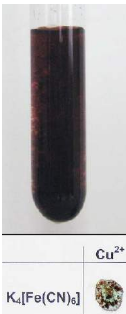
Czuła reakcja analityczna soli miedzi(II) z żelazocyjankiem potasu (u góry w probówce, u dołu na folii).
