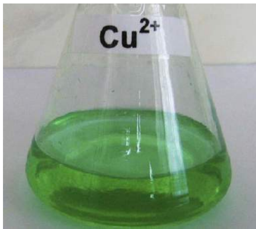
Chlorkowy kompleks miedzi(II) jest żółty, ale w połączeniu z jonami uwodnionymi daje zieloną barwę roztworu.
