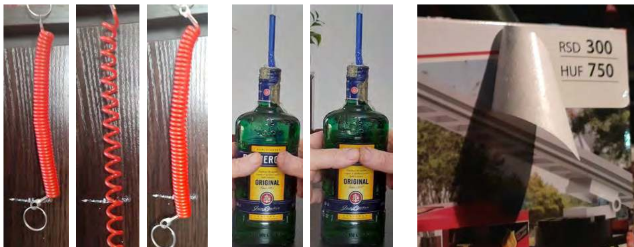
Ryc. 8. (a, b) Dwa doświadczenia z ciałami stałymi. (a) Polimer, który wykazuje histerezę kształtu: sprężyna rozciągnięta do 4-krotnej długości, po usunięciu siły potrzebuje kilkunastu sekund, aby wrócić do pierwotnego rozmiaru (środkowa fotografia zrobiona 3 sekundy po usunięciu siły rozciągającej). (b) Sprężystość szkła. Płaska butelka o pojemności 500\text{ cm}^3 , ściśnięta „z całej siły” dwoma kciukami zmniejsza swą objętość o około 0,5\text{ cm}^3 . Dla lepszej wizualizacji warto użyć węższej słomki. Idea: mgr Hieronim Ratajczak. Foto: M. Karwasz, kciuki GK. (c) Klej to też ciecz nie-newtonowska: zrywając etykietę z pudełka z zabawkami należy ciągnąć powoli – wówczas klej „płynie” pod wpływem niewielkiej siły a papier nie zrywa się (= kolejna kompetencja praktyczna).
