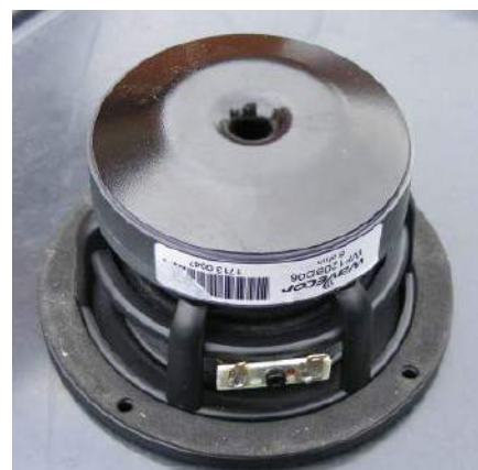
Rysunek 7. Widok tyłu głośnika niskotonowego Wavecor WF120BD06; zauważ obszerne odpowietrzenie.
