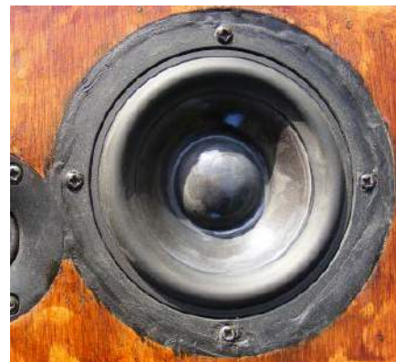
Rysunek 6. Głośnik niskotonowy Wavecor WF120BD06 do mini-monitora PE oraz front głośnika niskotonowego Wavecor zamontowany w skrzyni (proszę zwrócić uwagę na membranę z dopingiem).
