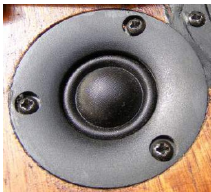
Rysunek 5. Zamontowany głośnik wysokotonowy Wavecor TW022WA04 do mini-monitora PE.
