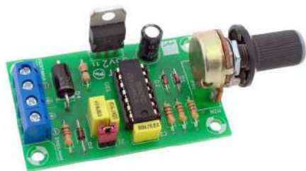
AVT735 Regulator mocy PWM 10 A https://sklep.avt.pl/avt735.html
