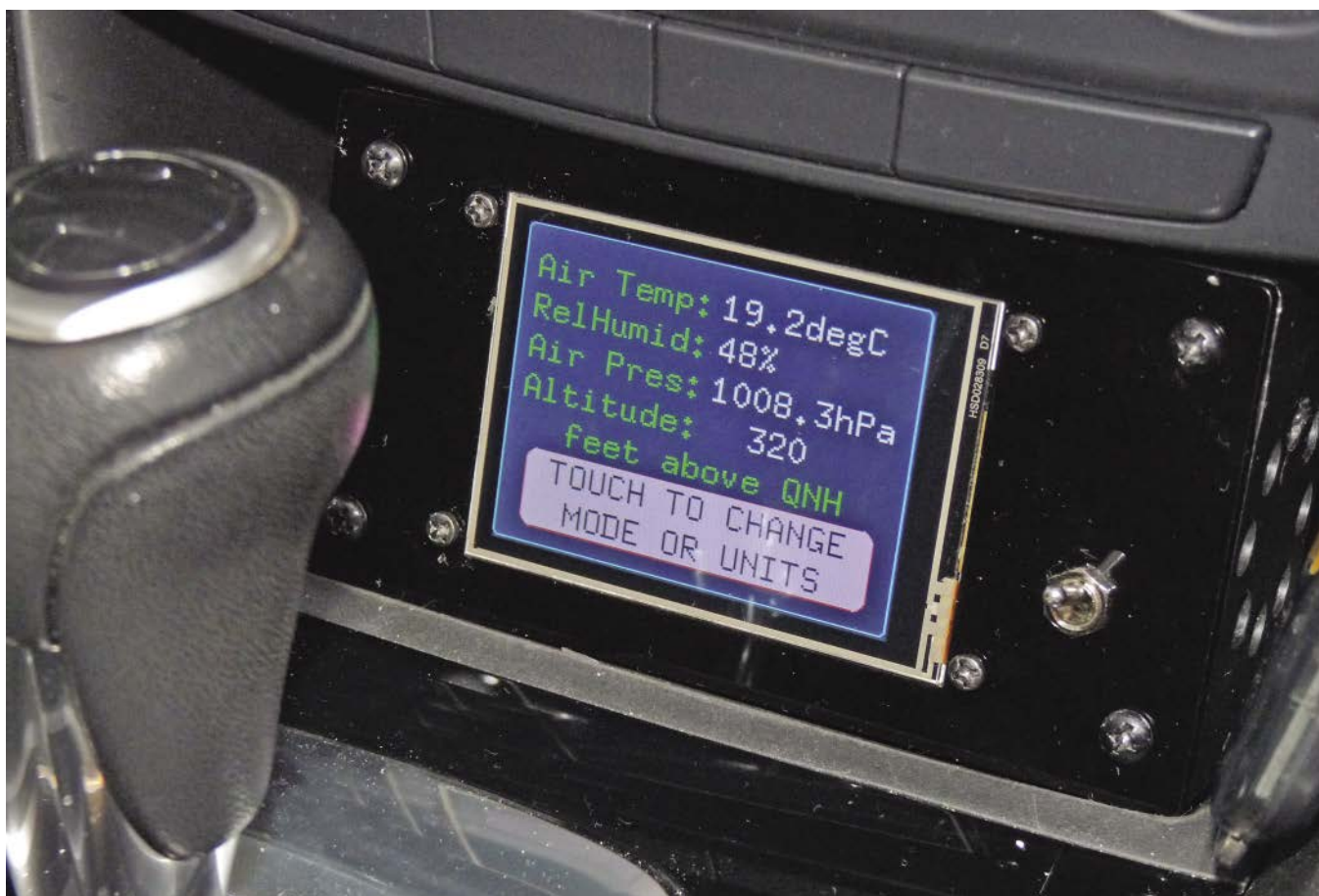
Oto wysokościomierz wbudowany w standardowe (DIN) wycięcie w desce rozdzielczej mojego samochodu. Ponieważ ma duży ekran, jest bardzo czytelny. Jak widać na ekranie, można zmienić zarówno tryb wyświetlania, jak i jednostki (np. stopy nad poziomem morza, jak pokazane tutaj [wg konwencji używanej w lotnictwie] na metry nad poziomem morza, co wszyscy znamy). Nawiasem mówiąc, QNH oznacza ciśnienie atmosferyczne skorygowane do średniego poziomu morza. Nie jest ono ani stałe, ani takie samo dla różnych miejsc – QNH można uzyskać od serwisów pogodowych.
