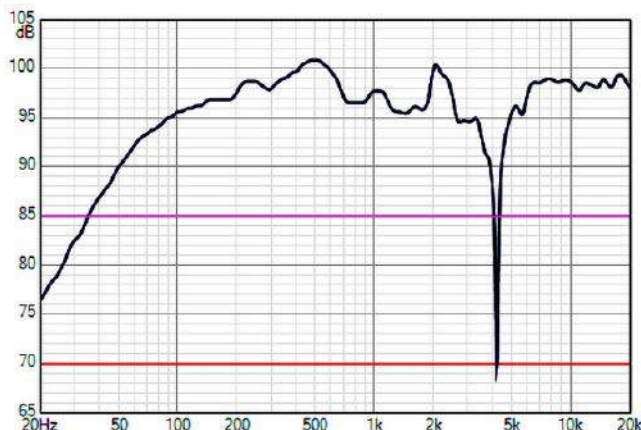
Rysunek 1.21. Wypadkowa charakterystyka poziomu ciśnienia akustycznego w funkcji częstotliwości zestawu głośnikowego w obudowie typu „Zeus” (głośnik wysokotonowy podłączony afazowo)
