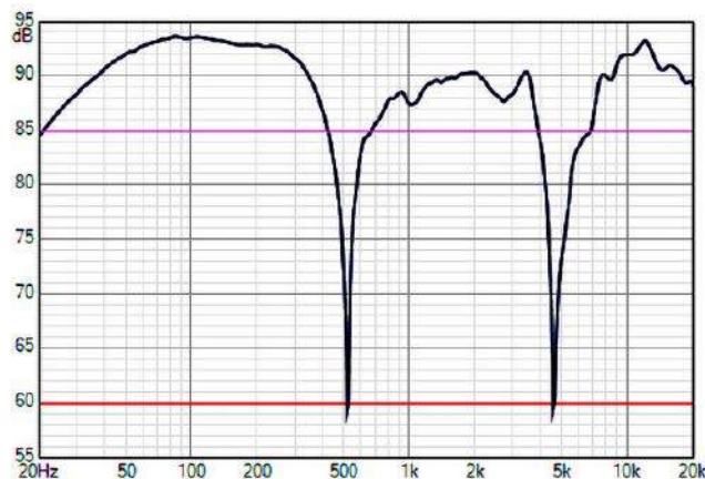
Rysunek 1.12. Wypadkowa charakterystyka poziomu ciśnienia akustycznego w funkcji częstotliwości zestawu głośnikowego w obudowie typu „Altus 300” (głośnik średniotonowy podłączony afazowo)
