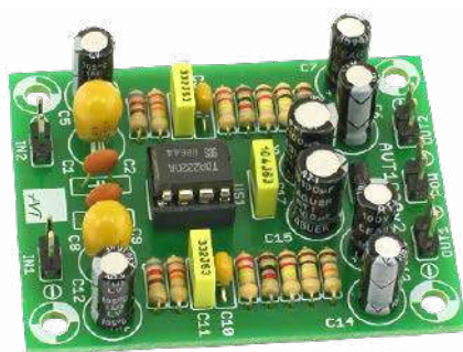
AVT1023 Przedwzmacniacz gramofonowy o charakterystyce RIAA https://sklep.avt.pl/avt1023.html
