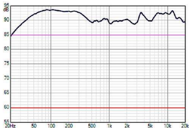
Rysunek 1.11. Wypadkowa charakterystyka poziomu ciśnienia akustycznego w funkcji częstotliwości zestawu głośnikowego w obudowie typu „Altus 300” (wszystkie głośniki podłączone synfazowo)
