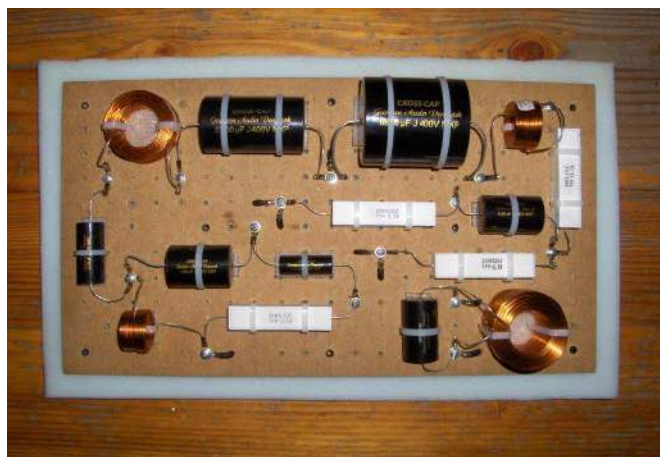
Rysunek 1.9. Zwrotnica zestawu głośnikowego w obudowie typu „Altus 300” – tor średniotonowy i wysokotonowy
