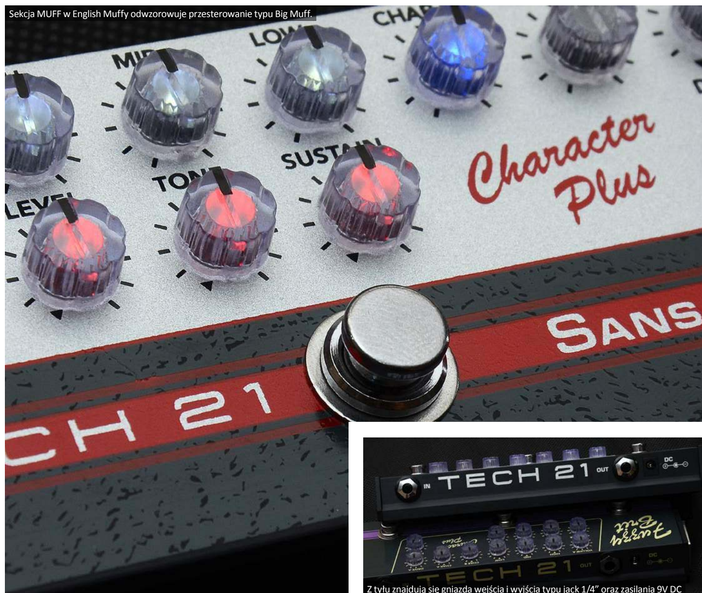
Z tyłu znajdują się gniazda wejścia i wyjścia typu jack 1/4" oraz zasilania 9V DC
