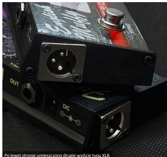
Po lewej stronie umieszczono drugie wyjście typu XLR.
