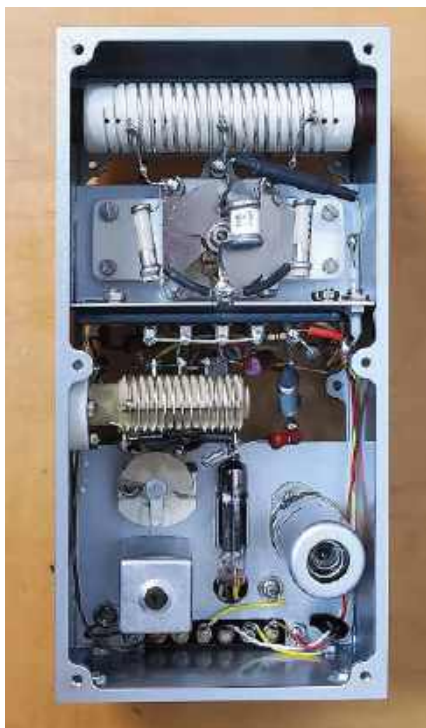
Zdjęcia 7 i 8. Zmontowana i działająca replika nadajnika 20,005 MHz
