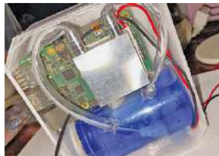
Rysunek 12. Mocowanie modułu chłodzenia wodnego
