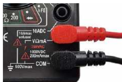
Fotografia 16. Poprawne podłączenie kabli na przykładzie multimetru DT-830B, ustawionego na funkcję woltomierza napięć statycznych
