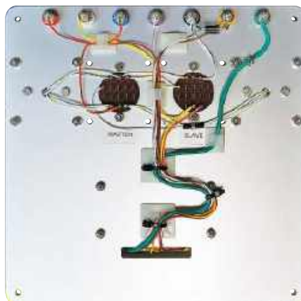
Zdjęcie 24. Wiązka kablowa na spodzie podstawy (której nie ma na zdjęciu 23). Zwróćmy uwagę na diodę Zenera na zasilaniu 7,5 V. Została ona dodana w celu ochrony żarników lamp przed przypadkowym podaniem zbyt wysokiego napięcia
