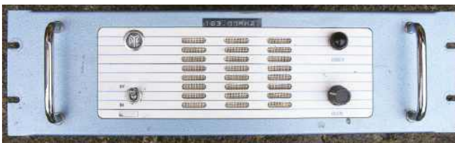
Rysunek 26. Płyta czołowa policyjnego radia produkcji Pye Vanguarda; konstrukcja z roku 1965; radio to było z powodzeniem użytkowane jeszcze w latach 80. XX wieku
