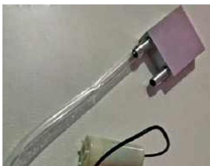
Rysunek 8. Aluminiowy blok wodny do chłodzenia
