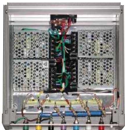
Zdjęcie 23. W obudowie mieszczą się cztery zasilacze impulsowe. Trochę miejsca zabierają też rezystory, kondensatory i diody Zenera. Układ jest na tyle prosty, że płytka drukowana nie była konieczna
