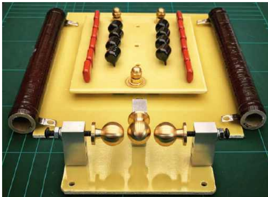
Zdjęcie 4. Iskiernik bezpieczeństwa. Zawiera trzy mosiężne gątki dotychczas dołączone do filtra Terry’ego. Elementy są już rozmieszczone, ale jeszcze nie połączone. Gątki zostały umieszczone na blokach aluminiowych i ustawione tak, żeby można było regulować ich położenie
