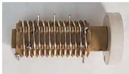
Zdjęcie 10. Miałem szczęście, że znalazłem w Wielkiej Brytanii taki karkas cewki. Jest bardzo zbliżony do oryginalnego. Musiałem tylko dorobić podstawę
