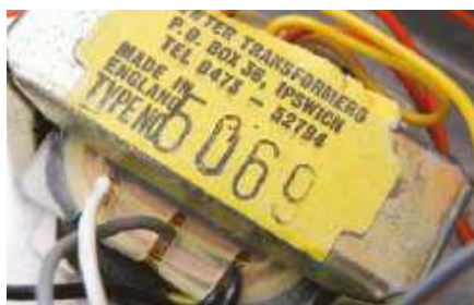
Rysunek 30. Wygląd zewnętrzny transformatora Sowter 5069; żółty przewód łączy zewnętrzną i wewnętrzną sekcję uzwojenia pierwotnego
