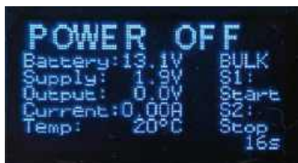
Ekran 4. Wyświetlany w przypadku braku zasilania – gdy zostało ono wyłączone lub odłączone. Napięcie wyjściowe jest wówczas niskie, a prąd wskazywany jako 0,00 A. Licznik w prawym dolnym rogu odlicza czas do wyłączenia wyświetlacza. Można go ponownie włączyć, naciskając dowolny przycisk
