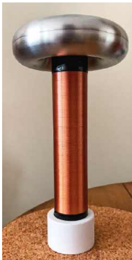
Zdjęcie 2. W podstawę części wtórnej zostało wbudowane złącze, aby część tę można było łatwo usunąć, gdy cewka Tesli nie jest używana. Złącze służy również jako uziemienie
