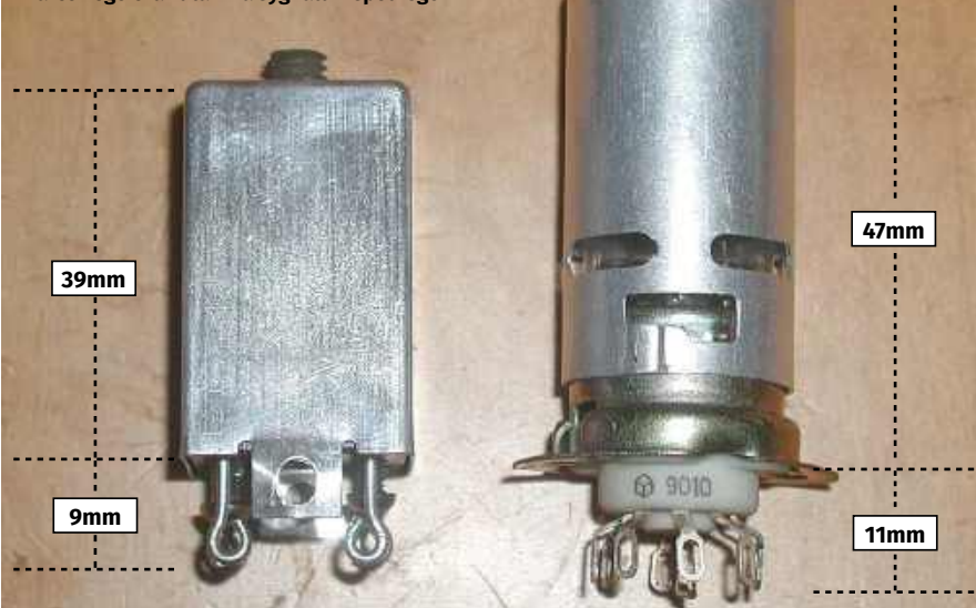
Zdjęcie 17. Wysokości puszek i gniazd rezonatora kwarcowego oraz dławika sygnału wspólnego
