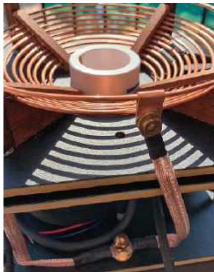
Zdjęcie 9. Do szyny ochronnej dodałem zacisk uzziemienia (po prawej)
