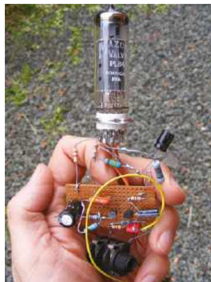
Rysunek 24. Model lampowego wzmacniacza gitarowego z rysunku 17; zastosowano tu transformator o symbolu B18A011F firmy Carnhill Transformers
