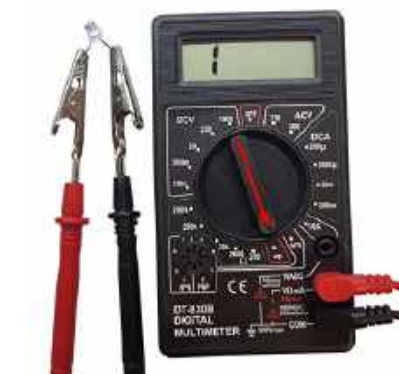
Fotografia 9. Sprawdzanie diody LED za pomocą multimetru ustawionego na testowanie diod. Po przyłożeniu sondy czerwonej do anody, a czarnej do katody, sprawna dioda LED powinna się zaświecić. Jeśli dioda ma odpowiednio długie (jeszcze nie przycięte) wyprowadzenia można się wspomóc krokodylkami
