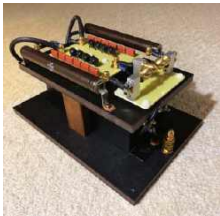
Zdjęcie 10. Transformator do oświetlenia neonowego został zmontowany na podstawie o grubości 12 mm wykonanej ze SwitchPanel. Do zamocowania nad nim filtra Terry'ego zostały użyte drewniane wsporniki
