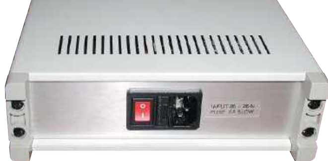
Zdjęcie 22. „Eliminator baterii” czyli zasilacz sieciowy, wbudowany do bardzo ładnej obudowy. Wszystkie napięcia wymagane do zasilania Manipulatora i nadajnika są wprowadzone na panel przedni na gniazda bananowe. Gniazdo sieciowe IEC, wyłącznik zasilania i bezpiecznik stanowią jeden element i znajdują się na tylnym panelu
