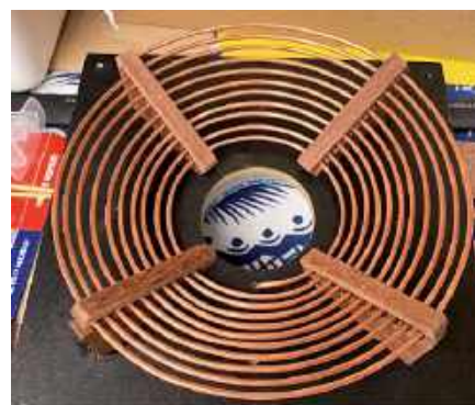
Zdjęcie 3. Zdecydowałem się na stożkową podstawę o kącie 30°, z regulowaną podstawą wykonaną z twardego drewna
