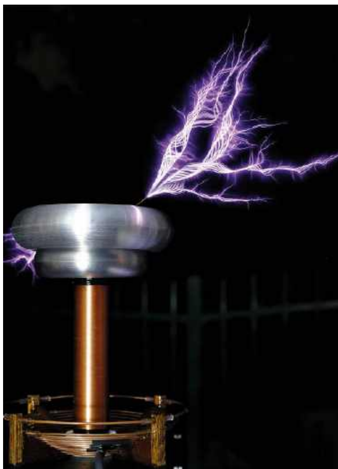
Zdjęcie 14. Umieszczenie na starym toroidzie nowo zakupionego większego toroidu pozwoliło uzyskać silniejsze wyładowania. Byłem zadowolony z rezultatu, więc ostatecznie toroidy zespawałem ze sobą, a następnie wyściłem je i wypolerowałem, co poprawiło ich wygląd i sprawność działania
