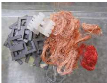
Rysunek 32. Rozebany międzystopniowy transformator Greenweld X7920 ujawnia dużą ilość cienkiego drutu nawojowego, nylonowy karkas oraz blachy transformatorowe rdzenia
