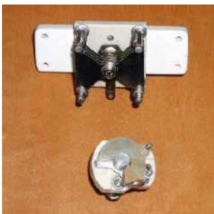
Zdjęcie 14 i 15. Ostrona oryginalnej nakrętki regulacyjnej trymera oscylatora, wykonana z zabytkowego klipsu montażowego do tranzystorów germanowych
