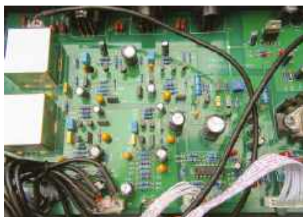
Rysunek 33. Przedwzmacniacz mikrofonowy będący negatywnym przykładem w zakresie skuteczności ekranowania transformatorów wejściowych; ekrany z cienkiej blachy stalowej nie chronią skutecznie przed zewnętrznym zakłócającym polem magnetycznym
