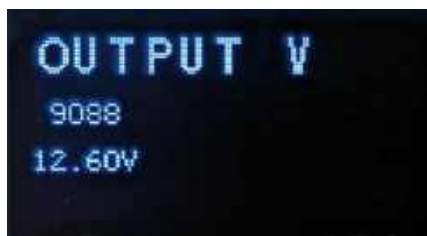
Ekran 5. Stałe kalibracyjne dla trzech napięć oraz prądu wyświetlanego na stronie głównej można regulować na tej stronie za pomocą przycisków S1 i S2. Nowo przeliczona wartość jest wyświetlana i może zostać łatwo porównana z odczytem z multimetru
