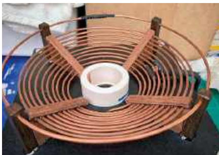
Zdjęcie 8. Najbardziej zewnętrzna rurka miedziana to szyna ochronna, która została dodana w celu ochrony obwodu pierwotnego przed łukiem elektrycznym
