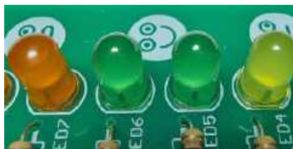
Fotografia 8. Przykład poprawnie zamontowanych diod LED. Płaskie ścięcia na obwodach diod LED muszą pokrywać się z fragmentem linii prostej w obrysie komponenty zaznaczonym na płytce
