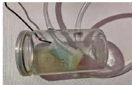
Rysunek 3. Rury wlotowe i wylotowe umocowane w zbiorniku wody
