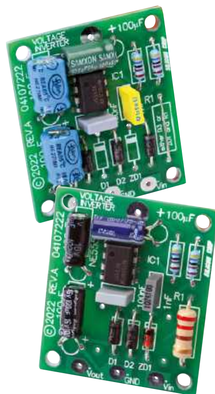
Zarówno moduł podwajacza napięcia (u góry), jak i moduł inwertera (u dołu) wymagają jedynie układu scalonego timera 555 i kilku innych elementów
