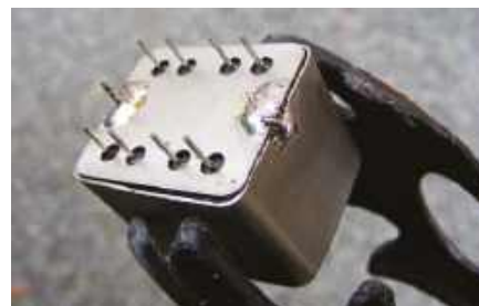
Rysunek 36. Górna część ekranu także musi być (na krótko) zwarta z podstawą i uziemieniem
