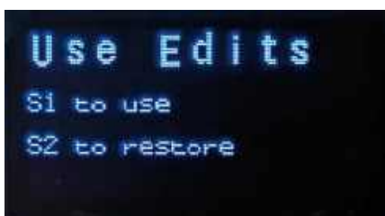
Ekran 8. Żadna ze zmian wprowadzonych na wcześniejszych stronach nie jest aktywowana natychmiast. Aby je zastosować, należy nacisnąć przycisk S1. Przycisk S2 przywraca wcześniejsze wartości. Wyświetlany tekst zmienia się, aby wskazać, że przycisk został naciśnięty
