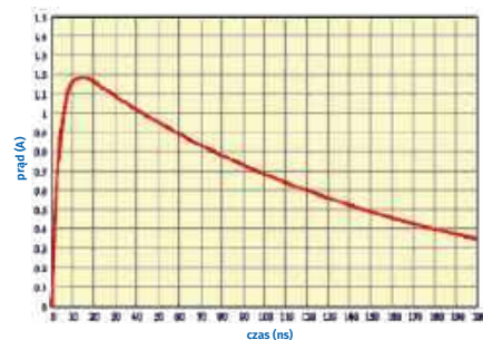
Typowy przebieg prądu rozładowania w przypadku wyładowania modelu ciała ludzkiego (HBM) do testowanego elementu (© 2018 Jos Verstraten)
