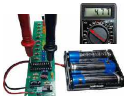
Fotografia 17. Pomiar na zaciskach 20 („plus”) i 10 („minus”) podstawki pod mikrokontroler AT-Tiny2313 wskazał poprawne napięcie baterii (bez znaku „-”, który sugerowałby błędną polaryzację). Można teraz odłączyć zasilanie i zamontować mikrokontroler w podstawce
