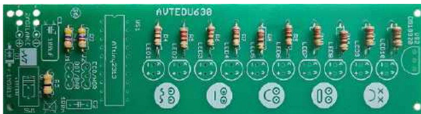
Fotografia 3. Rezystory są elementami bez polaryzacji i montujemy je na odpowiednich pozycjach, zgodnie z wykazem elementów, w dowolnym kierunku. Wartość każdego z rezystorów warto dla pewności zmierzyć za pomocą multimetru, lub sprawdzić, czy kolejność kolorów kodu paskowego jest zgodna z powyższą fotografią
