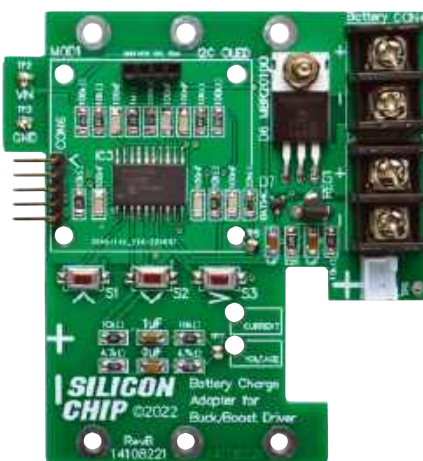
Rysunek 2. Moduł ładowarki zawiera elementy zarówno do montażu powierzchniowego jak i przewlekane. Powinien być łatwy w montażu. Jeśli zadbasz o prawidłowy kierunek montażu IC3 i nie pomylisz (nieoznakowanych) kondensatorów, nie powinieneś mieć żadnych problemów podczas uruchamiania. Cztery punkty testowe są od spodu wyposażone w gniazda do podłączenia do pinów na przetwornicy – szczegóły na zdjęciach
