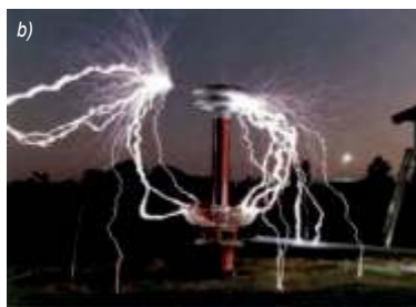
Fotografia 17, 18. a) Domowej roboty cewki Tesli w działaniu, pokazująca wyładowania szczotek z toroidu. Wysoka wartość pola elektrycznego powoduje, że powietrze wokół złącza doprowadzane jest do jonizacji i przewodzenia prądu elektrycznego, dzięki czemu następuje wyciekanie do powietrza kolorowych wyładowań koronowych w kształcie „wyładowania pędzla” i „płoszących łuków”.
