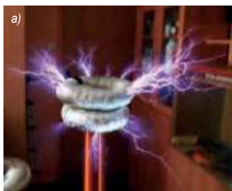
Fotografia 17, 18. a) Domowej roboty cewki Tesli w działaniu, pokazująca wyładowania szczotek z toroidu. Wysoka wartość pola elektrycznego powoduje, że powietrze wokół złącza doprowadzane jest do jonizacji i przewodzenia prądu elektrycznego, dzięki czemu następuje wyciekanie do powietrza kolorowych wyładowań koronowych w kształcie „wyładowania pędzla” i „płoszących łuków”.
