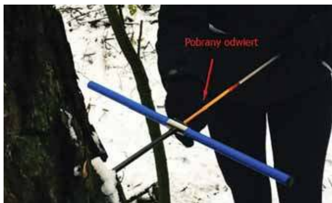
Ryc. 1. Pobór próby dendrochronologicznej za pomocą świdra Presslera
