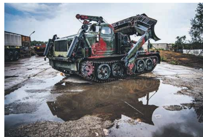
Gąsienicowa spycharka samobieżna BAT-M, potężna maszyna na każdy teren
