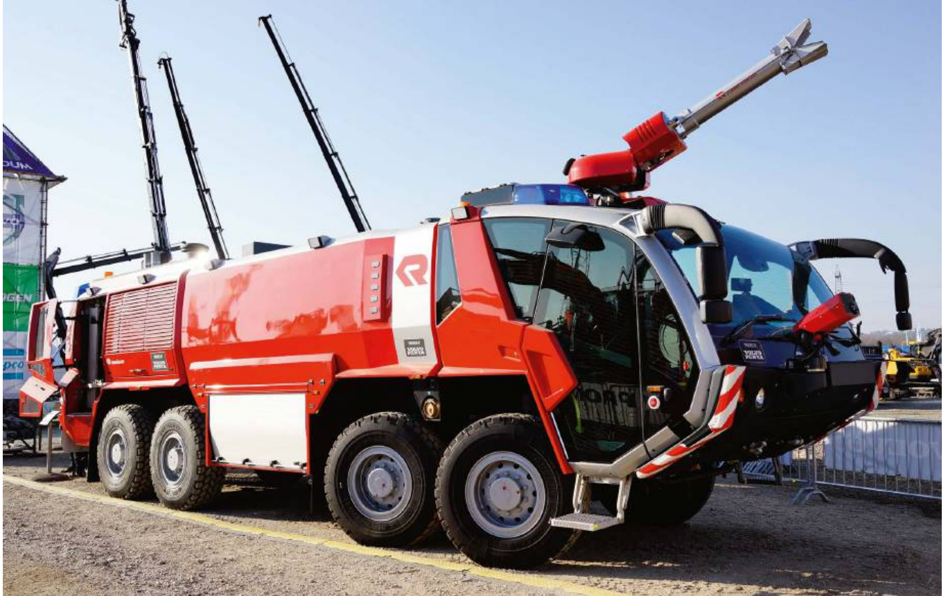
Lotniskowy pojazd ratowniczo-pożarniczy Rosenbauer Panther, wersja ośmiokołowa, czyli największa – długość 13 m. Pojazdy Panther produkowane są w Austrii.
