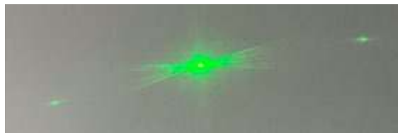
Rys. 5. Światło lasera przechodzące przez siatkę dyfrakcyjną, ulega dyfrakcji i interferencji, w wyniku czego obserwuje się naprzemienne jasne i ciemne prążki (w tym wypadku jasne prążki to kropki).
