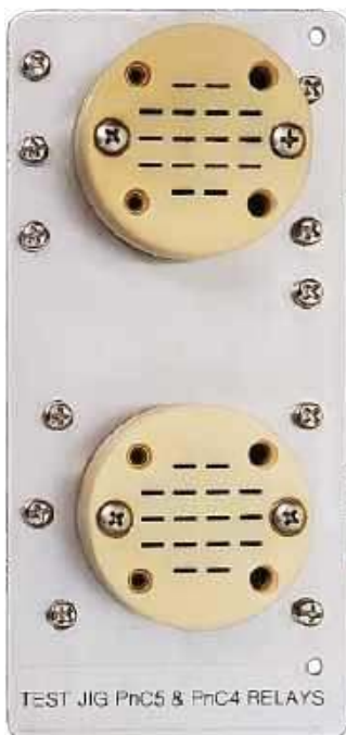
Zdjęcie 10 (po lewej): Wykonany przyrząd do testowania i regulowania przełączników, używając dwóch podstawek pasujących do przełącznika PnC5
