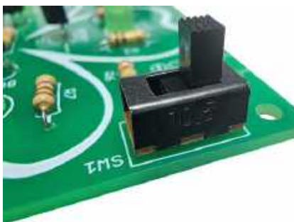
Fotografia 11. Poprawnie zamontowane włącznika zasilania SW1
