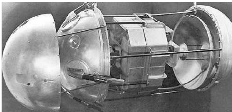
Zdjęcie 2: Co było w środku Sputnika? Wyraźnie widać ośmiokątny zestaw baterii, wewnątrz którego znajdował się moduł nadajnika D-200
