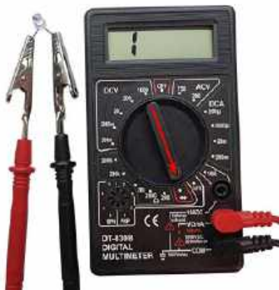
Fotografia 7. Sprawdzanie diody LED za pomocą multimetru ustawionego na testowanie diod. Po przyłożeniu sondy czerwonej do anody, a czarnej do katody, sprawna dioda LED powinna się zaświecić. Jeśli dioda ma odpowiednie długie (jeszcze nie przycięte) wyprowadzenia można się wspomóc krokodylkami
