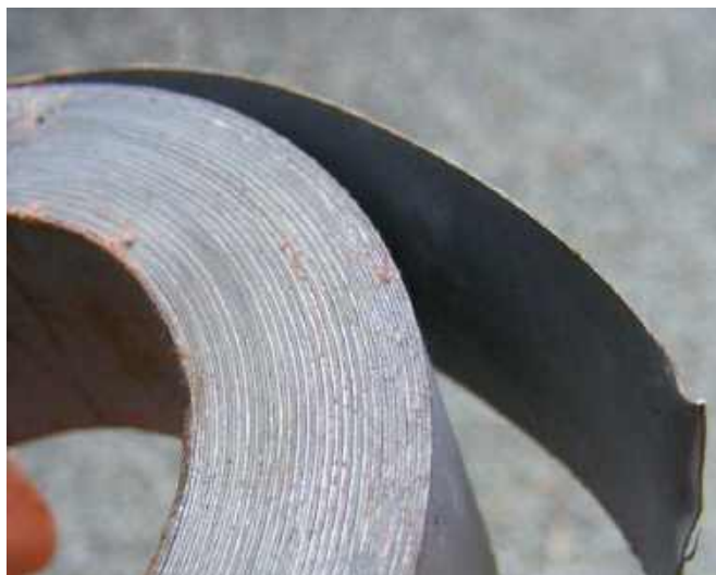
Rysunek 11. Rdzeń toroidalnego transformatora związany z długiej taśmy stalowej w kształt toroidu
