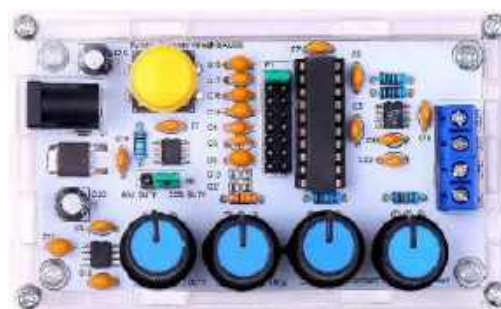
Analogowy generator funkcyjny z układem MAX038 (© AliExpress)
