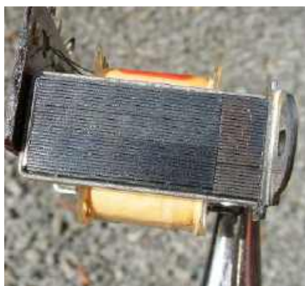
Rysunek 13. Porównaj ułożenie kształtek „E”-„I” w tym transformatorze z tym, co powiedziano w opisie związanym z rysunkiem 10. Jednostronne wsuwanie tych blaszek stwarza dodatkową szczelinę powietrzną, co pozwoli na przyjęcie większej składowej DC prądu bez efektu nasycenia się rdzenia. Tego typu rozwiązanie stosuje się w transformatorach wzmacniaczy klasy A oraz w cewkach (dławikach) zasilaczy filtrujących napięcie wyjściowe (które z zasady pracują z dużą składową stałą prądu). Sprawa ta jest problematyczna w transformatorach z rdzeniem toroidalnym, jako że, z zasady nie zawierają one żadnej szczeliny powietrznej (a cechują je inne istotne zalety). Jednak i na to znaleziono rozwiązanie w postaci tzw. szczeliny rozproszonej. Technologia polega na specjalnym „prasowaniu” materiału magnetycznego z którego później wykonany zostanie rdzeń transformatora. Sprawa jest jednak trudna, jeśli technologia wykonania rdzenia jest taka, jak pokazywał rysunek 11
