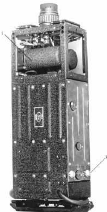
Zdjęcia 5 i 6: Nadajnik D-200, który leciał w Sputniku-1, pokazany z dwóch różnych ujęć. Na górze widać dwie duże puszkę przełączników, na których opiera się konstrukcja Manipulatora. Układy nadajnika znajdują się niżej
