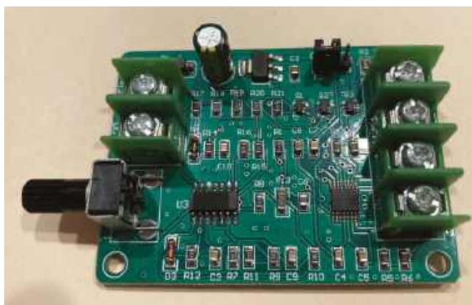
Rysunek 3. Prosty i tani sterownik silnika trójfazowego na 12 V
