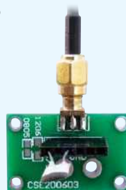
Opcjonalna płytka adaptera ułatwia testowanie komponentów
