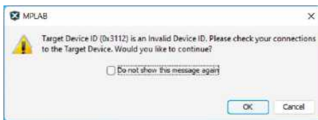
Ekran 1. Jeśli w trakcie programowania pojawi się komunikat o błędzie informujący, że 0x3112 to nieprawidłowy identyfikator układu PIC16F18146, można go bezpiecznie zignorować. Dokumentacja techniczna potwierdza, że 0x3112 to prawidłowy kod identyfikacyjny tego mikrokontrolera
