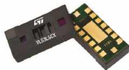
Rysunek 10. Czujnik odległości typu „Time-of-Flight” VL53L5CX z matrycą 8×8 (zdjęcie: STMicroelectronics)
