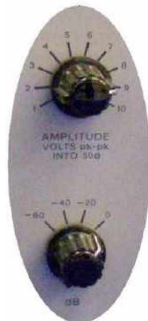
Praktyczna regulacja zakresu napięcia wyjściowego (© 2019 Jos Verstraten)
