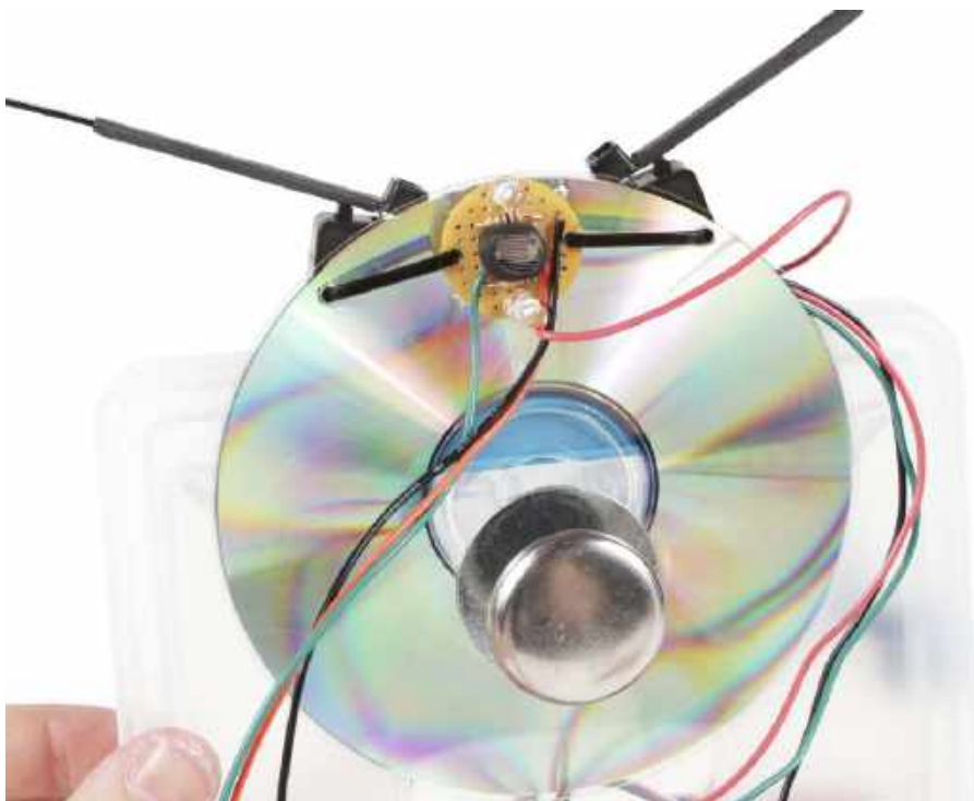
Fotografia 8. Sensor krawędzi zamontowany w robocie
