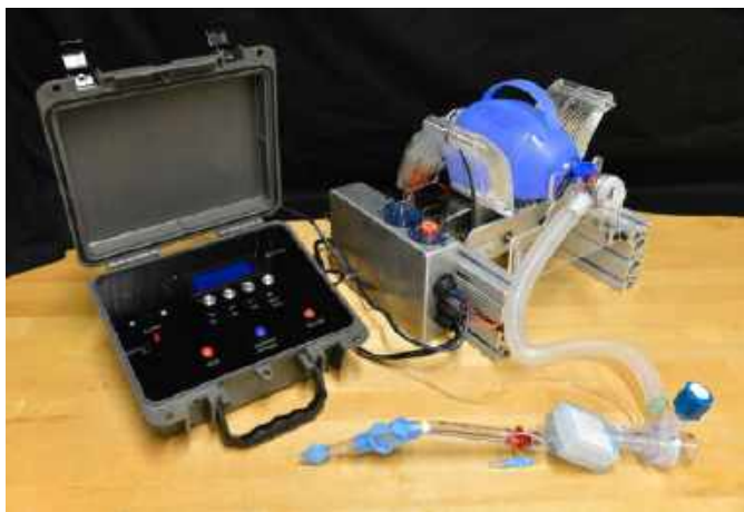
Fotografia 2. Otwarty projekt respiratora opracowanego przez MIT
