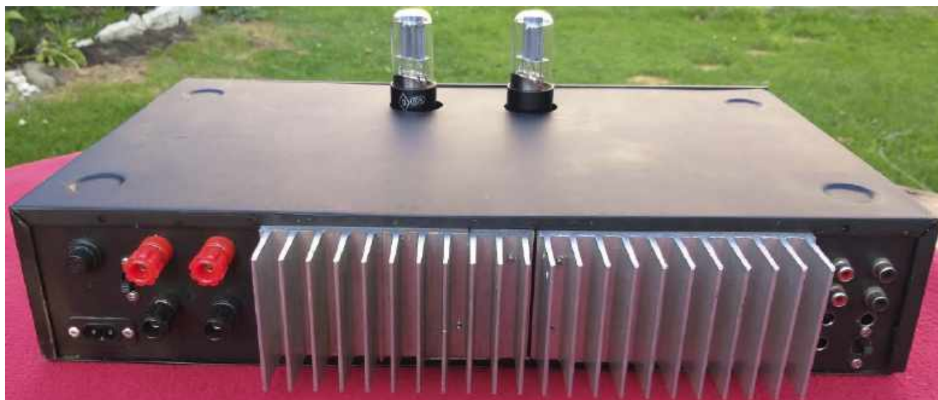
Fotografia 1. Konstrukcja tylnej ścianki obudowy wzmacniacza
