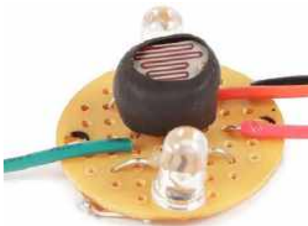
Fotografia 7. Zmontowany sensor krawędzi
