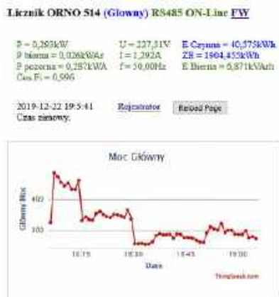
Rysunek 5. Strona www, na której można zobaczyć aktualne parametry monitorowane przez licznik
