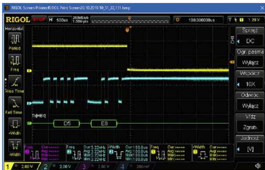
Rysunek 2. Kierunek transmisji RS485 jest zmieniany po wystąpieniu znaku, co pokazuje oscylogram
