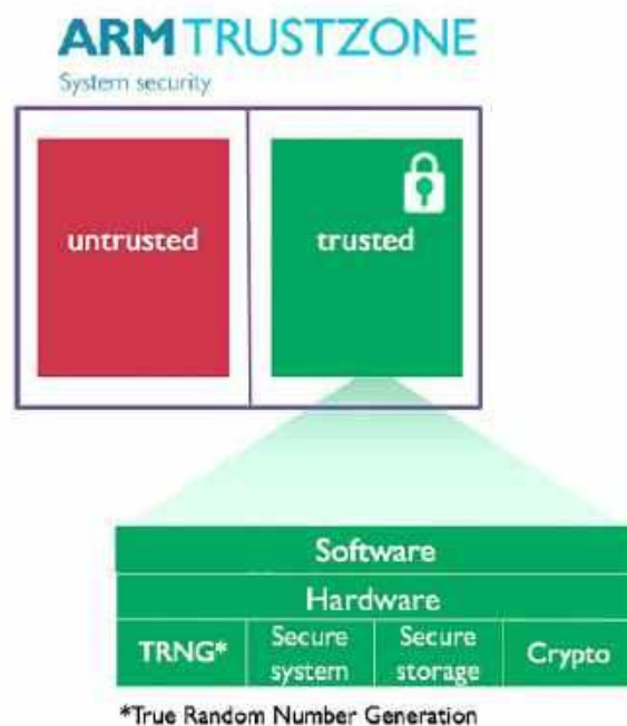
Rysunek 1. W dużej liczbie układów z rdzeniem ARM jest dostępny mechanizm TrustZone
