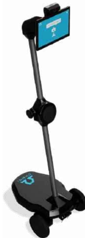
Fotografia 6. Rozbudowany system teleobecności z możliwością przemieszczania
