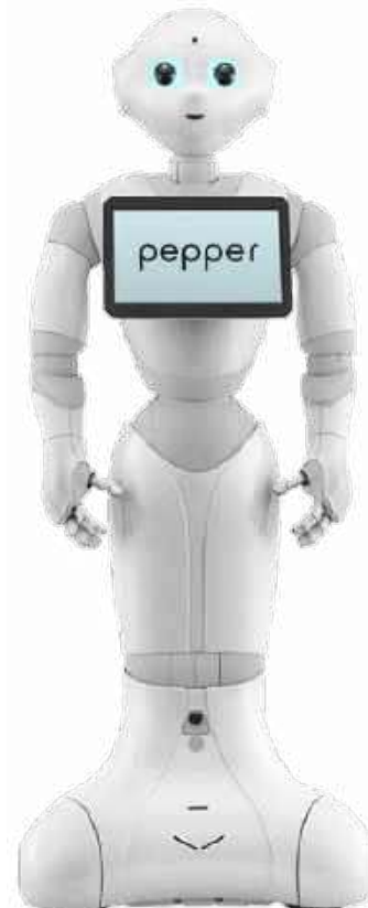
Fotografia 7. Robot przeznaczony do realizacji teleobecności
