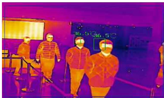
Fotografia 2. Obraz kamery termowizyjnej firmy HikVision, wyposażonej w system identyfikujący temperaturę ludzi
