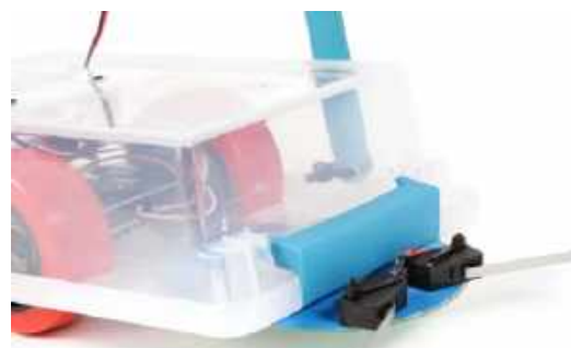
Fotografia 6. Moduł detektora zamontowany w jeżdżącej podstawie
