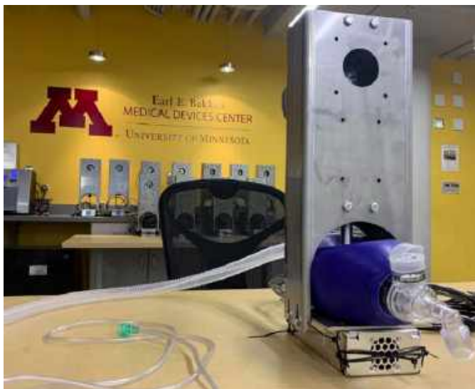
Fotografia 4. Respirator opracowany na University of Minnesota
