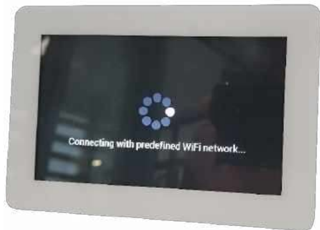
Fotografia 2. Ekran z obiektem typu Spinner , informujący użytkownika o postępie procesu
