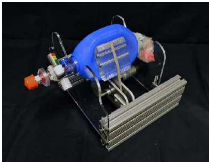
Fotografia 5. Respirator opracowany w Massachusetts Institute of Technology
