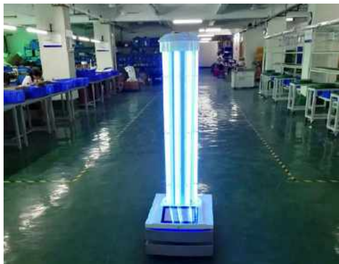
Fotografia 4. Robot dezynfekcyjny o dużym stopniu autonomii
