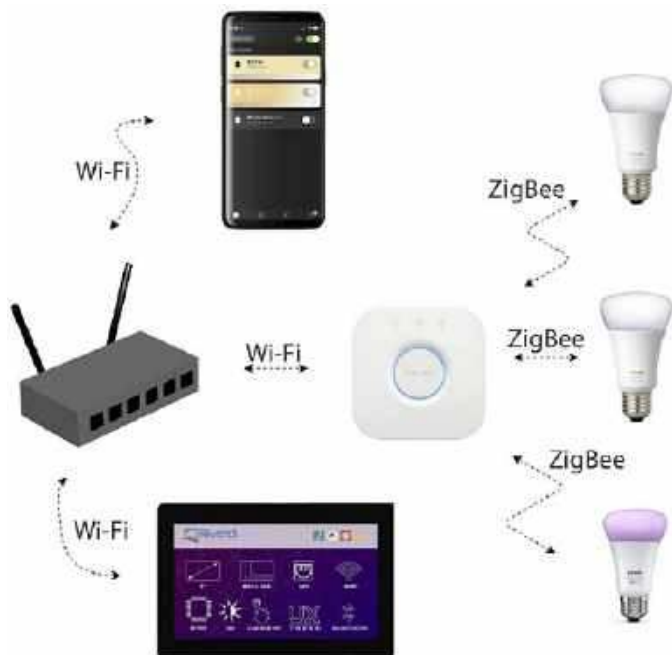
Rysunek 1. Schemat blokowy projektowanego systemu sterowania oświetleniem
