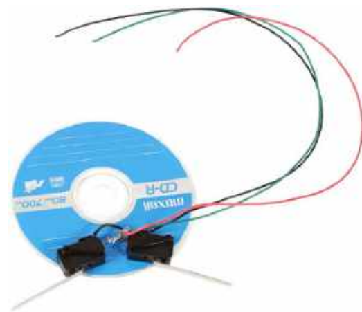
Fotografia 5. Moduł detektora zmontowany na płycie CD
