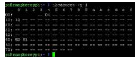
Rysunek 9. Detekcja układu SSM3582 na magistrali I 2 C
