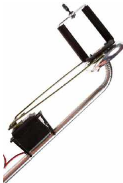
Fotografia 3. Sposób montażu smartfona w uchwycie z cięgnami
