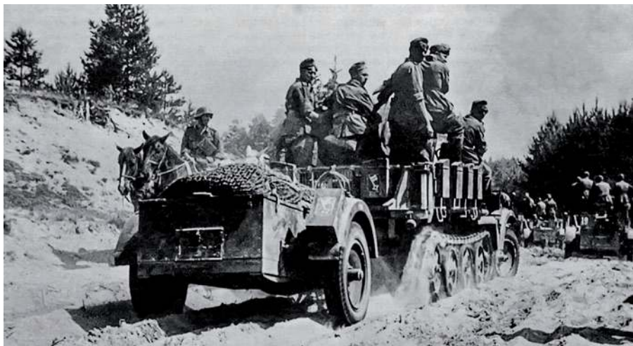
▲ Ciągłnik Sd.Kfz 10 z zainstalowanym na skrzyni automatycznym działkiem 20 mm. Pojazd był mobilnym środkiem obrony przeciwlotniczej maszerujących kolumn. Jednocześnie holował przyczepkę z zaopatrzeniem.
