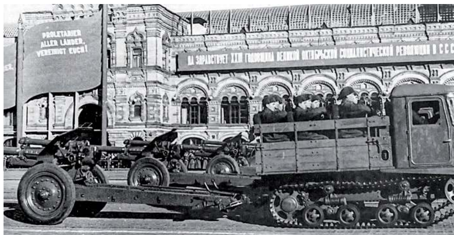
▲ Część artylerii korpusów zmechanizowanych należała do nowych i całkiem niezłych systemów artyleryjskich. Na zdjęciu 122 mm haubica M-30 holowana przez ciągnik STZ-5 (silnik o mocy 52 KM) przewożący także cały dział. Haubice tego typu były eksploatowane jeszcze wiele lat po zakończeniu wojny.
