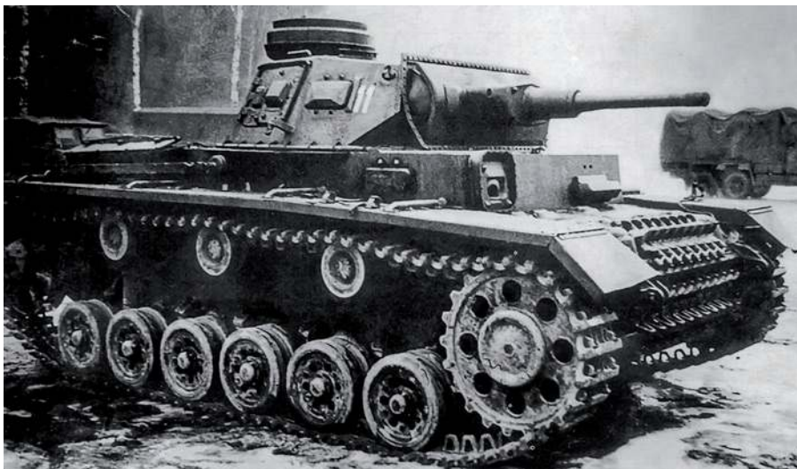
▲ Czołg średni Panzer III Ausf G z armatą 5,0 cm KwK L/42 w wariantcie Tauchpanzer dostosowanym do pokonywania przeszkód wodnych po dnie. Takie czołgi należące do 18. Dywizji Pancerniej 2. Grupy Pancerniej 22 czerwca przekroczyły Bug pod Brześciem.
