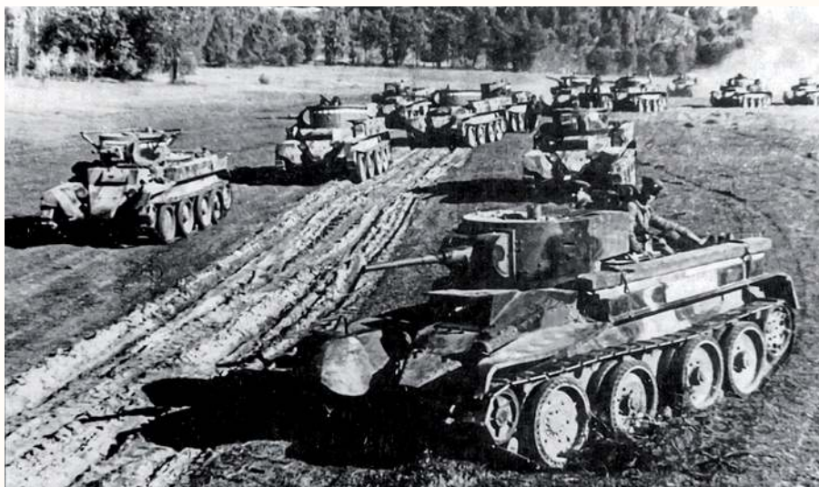
▲ Ćwiczenia z końca lat 30. z udziałem czołgów BT-5 (po prawej) i BT-7 (po lewej). Jak widać tylko pierwszy czołg po lewej jest wyposażony w radiostację. Część wozów ma jeszcze na wieżach oznaczenia przynależności do pododdziału a większość dwubarwny kamuflaż z ciemnobrązowych plam na oliwkowym tle.
