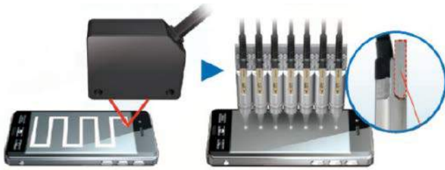
Rysunek 36. Zastosowanie konfokalnych czujników spektralnych pozwala na budowę kompaktowych systemów wielokanałowych, np. w aplikacjach analizy krzywizny powierzchni ( https://t.ly/rAUU8 )
