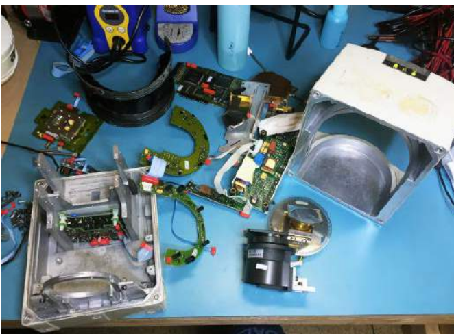
Fotografia 11. Wygląd wnętrza skanera laserowego SICK ( https://t.ly/d-G4P )
