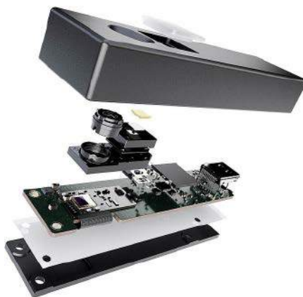
Fotografia 19. Widok rozstrzelony kamery flexx2 ( https://t.ly/AjM1w )
