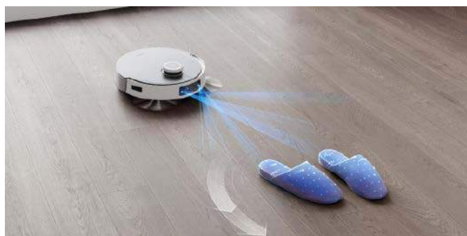
Rysunek 15. Technologia ToF przynosi znaczne korzyści robotyce mobilnej, m.in. automatycznym odkurzaczom – pozwala bowiem na detekcję oraz omijanie przeszkód z dużą precyzją i odpowiednim wyprzedzeniem ( https://t.ly/H_KBd )
