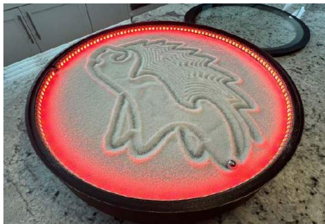
Fotografia 3. Gotowy układ z zainstalowanym podświetleniem i warstwą piasku na filcu
