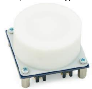
Fotografia 27. Zestaw ewaluacyjny dla modułu V-LD1 z zamontowaną soczewką ( https://t.ly/MSjUD )
