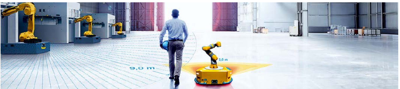
Fotografia 10. Przykłady zastosowania certyfikowanych skanerów bezpieczeństwa: ochrona przed wejściem w strefę roboczą manipulatorów przemysłowych oraz zabezpieczenie robota mobilnego przed kolizją ( https://t.ly/WoFg8 )
