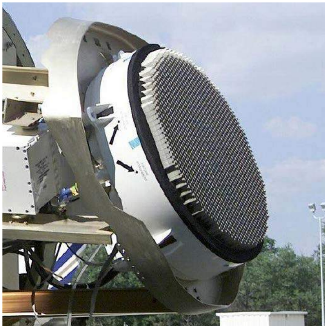
Fotografia 24. Współczesny zespół anten radarowych, wykorzystujący zryk fazowany ( https://t.ly/jglmk )
