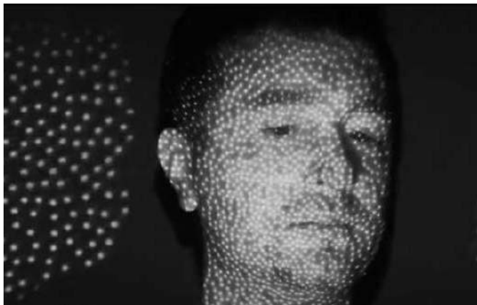
Fotografia 30. Macierz punktów świetlnych, rzutowana na twarz użytkownika przez projektor telefonu iPhone X ( https://t.ly/d0_b2 )
