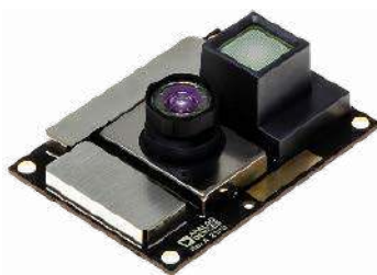
Fotografia 18. Zestaw ewaluacyjny do 1-megapikselowej kamery ToF marki Analog Devices ( https://t.ly/Gz_7Z )
