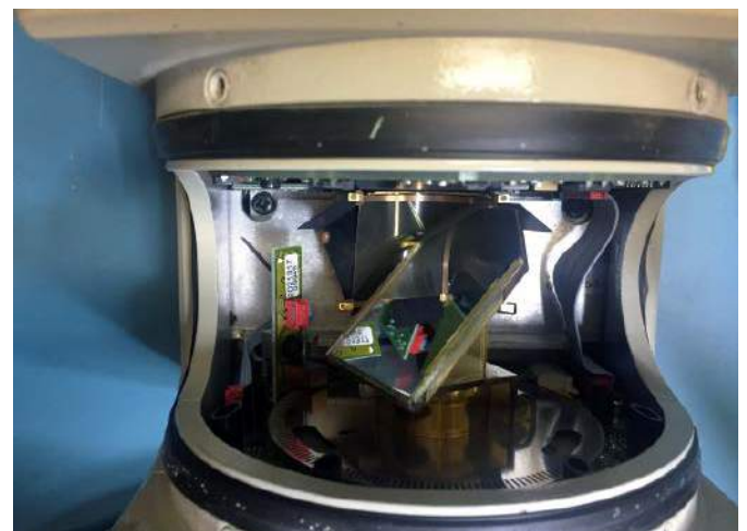
Fotografia 12. Lustro obrotowe, zastosowane w skanerze laserowym marki SICK ( https://t.ly/d10Tu )
