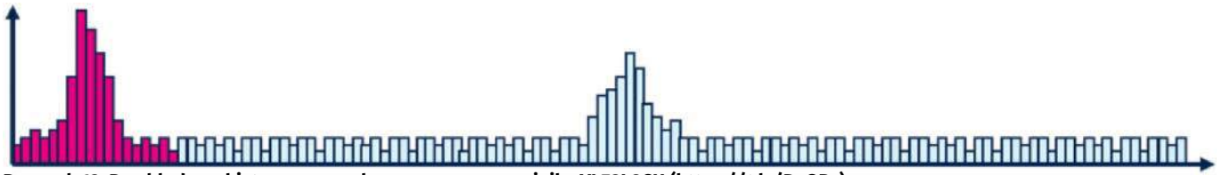
Rysunek 13. Przykładowy histogram, uzyskany za pomocą czujnika VL53L8CH ( https://t.ly/DyQB5 )
