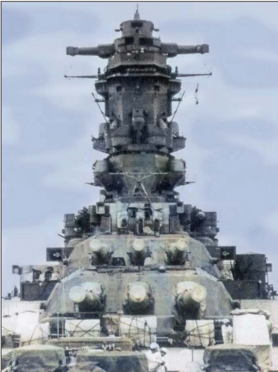
Przednie wieże artylerii głównej kal. 460 mm i pomocniczej (ciężkiej) kal. 155 mm oraz nadbudówka pancernika Musashi w 1942 r.
