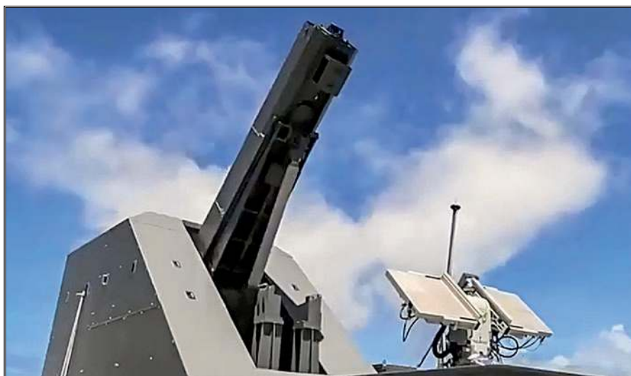
Japońska armata elektromagnetyczna przeszła już pierwsze próby morskie. Broń ta cechuje się ogromnym zapotrzebowaniem na energię elektryczną oraz szybkim zużywaniem przewodnic (powtarzalność salw). Nowe pancerniki są tu panaceum na problem ze względu na znacznie większe zapasy mocy.
