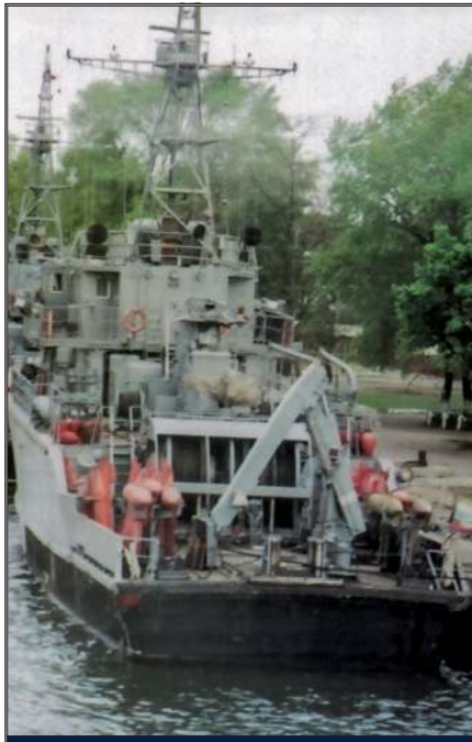
Widok na pokład rufowy jednego z trałowców projektu 1265 z dobrze widocznymi elementami wyposażenia trałowego. Kolor ma ułatwić ich dostrzeżenie po postawieniu w wodzie.
