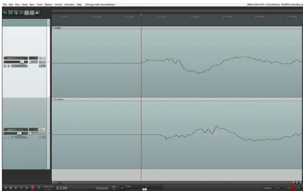
Brak zgodności fazowej, wynikającej z różnic czasowych, powodowanych dystansem od źródła dźwięku.
