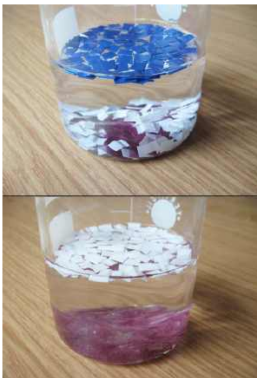
5. Widok próbek tworzyw w zlewce po wleciu wody (u góry) oraz po zebraniu niebieskich fragmentów i dosypaniu soli do wody (na dole)
