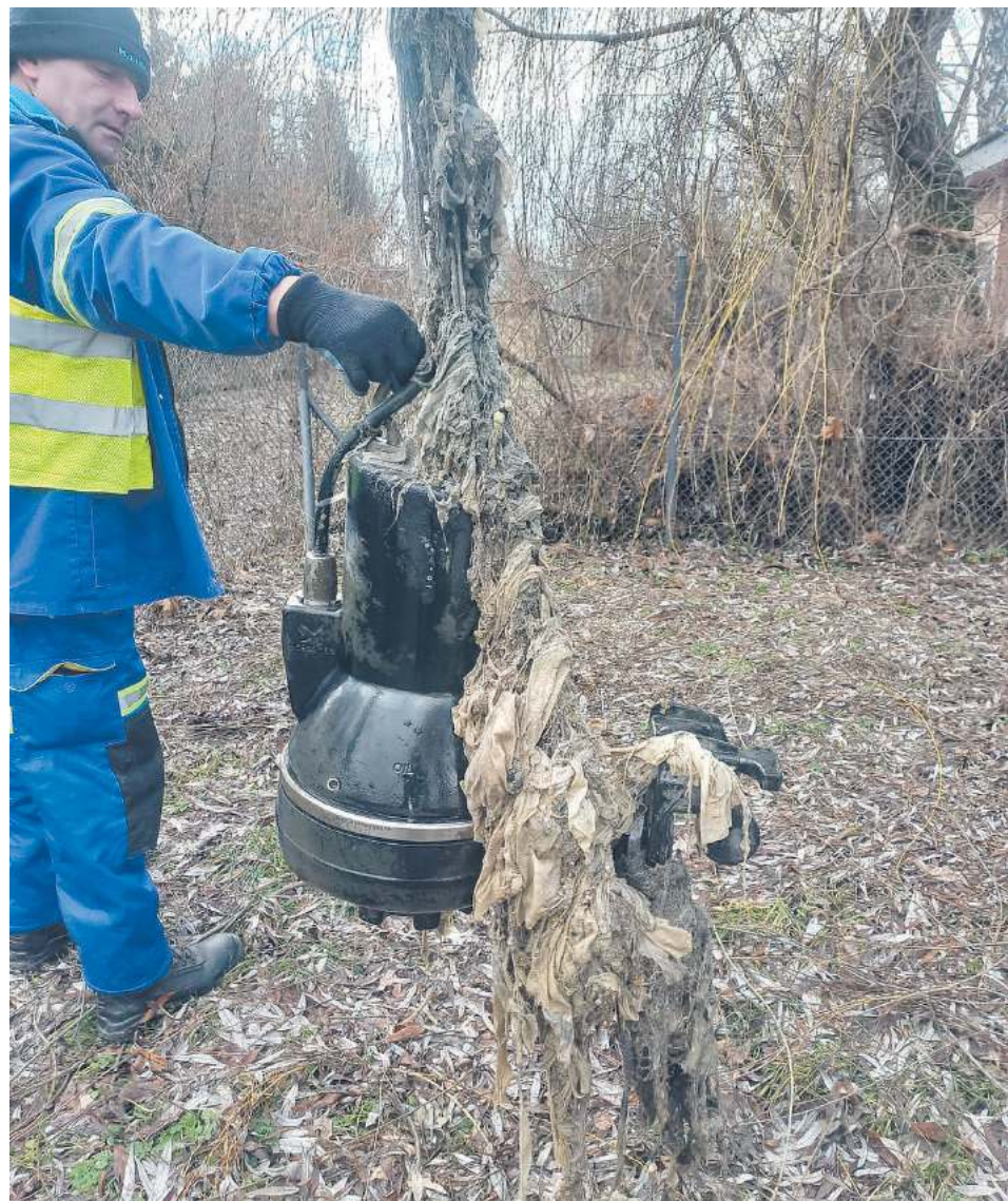
Chusteczki nawilżane zbite w warkocz, wyjęte z zapchanej pompy przepompowni ścieków
