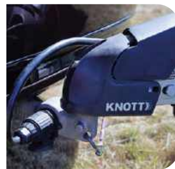
Prawidłowe zapięcie linki zrywki to czynność decydująca o bezpieczeństwie. Powinna być ona zaczepiona w dedykowanym do tego miejscu, nie zaś wokół szyjki zaczepu holowniczego
