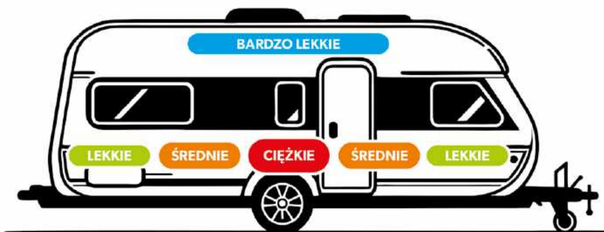
Odpowiednie rozłożenie ładunku w przyczepie ma bezpośredni wpływ na bezpieczeństwo podczas jazdy
