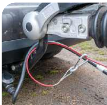
Prawidłowe zapięcie linki zrywki to czynność decydująca o bezpieczeństwie. Powinna być ona zaczepiona w dedykowanym do tego miejscu, nie zaś wokół szyjki zaczepu holowniczego
