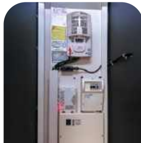
Wewnątrz szafy zlokalizowanej między łazienką a sypialnią znajduje się centrala elektryczno-elektroniczna przyczepy. Stąd też najbliższe do akumulatora, który pozwala na pewną autonomię energetyczną
