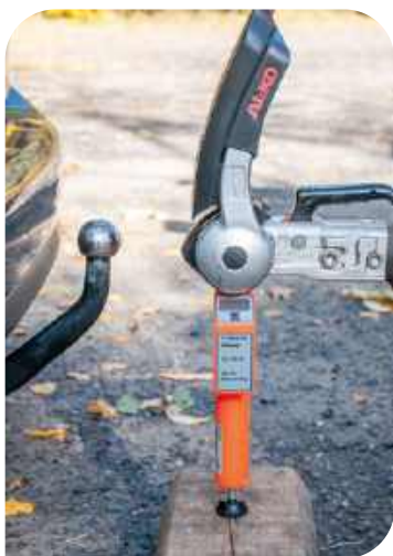
Nacisk przyczepy na kulę haka, czyli obciążenie pionowe, można mierzyć precyzyjnie za pomocą specjalnej wagi
