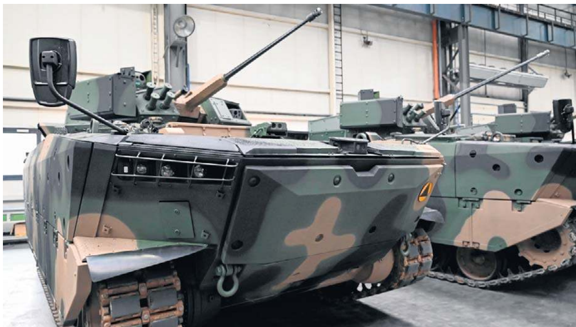
Borsuki są wyjątkowo ciężkie, ważą po 26 ton. Równocześnie są to pojazdy pływające
