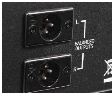
Gniazda są bardzo porządne; XLR-y dostarczył Neutrik.
