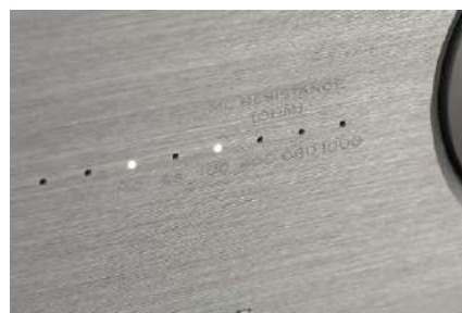
Zestaw obciążeń dla wariantu MC jest dość typowy, obok umieszczono jeszcze wskaźnik „SS” potwierdzający załączenie filtra subsonicznego.
