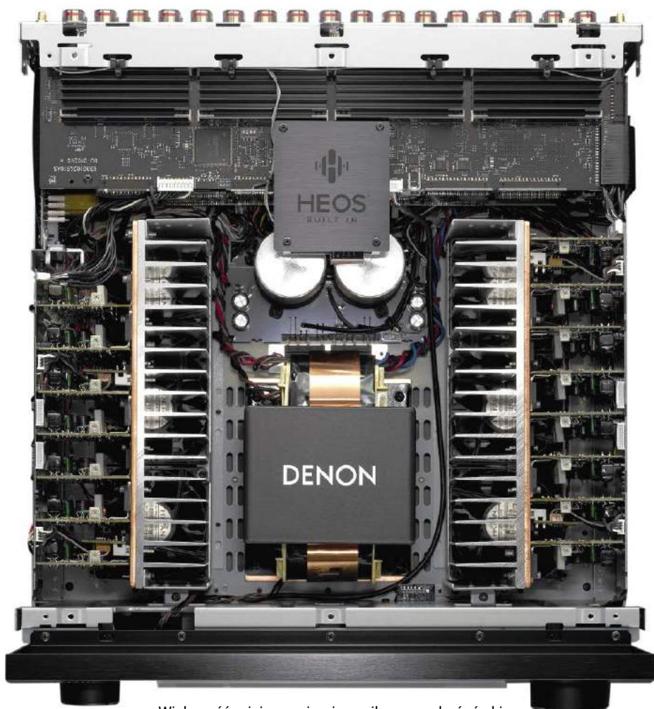
Większość miejsca zajmują zasilacz oraz końcówki mocy, pozostałe układy (ułożone na kilku „piętrach”) ulokowano w pobliżu tylnej ścianki
