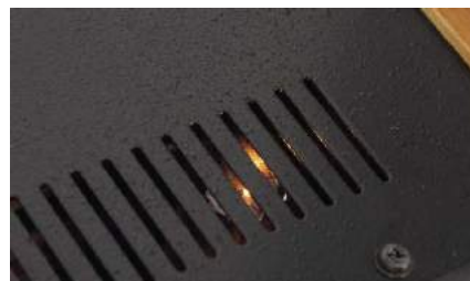
Szczeliny w górnej pokrywie ujawniają lampy i zapewniają ich chłodzenie.
