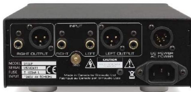
Ani z przodu, ani z tyłu, ani z boku; ani na wierzchu, ani pod spodem... nie ma żadnych przełączników; aby wyregulować parametry trzeba dostać się do środka.
