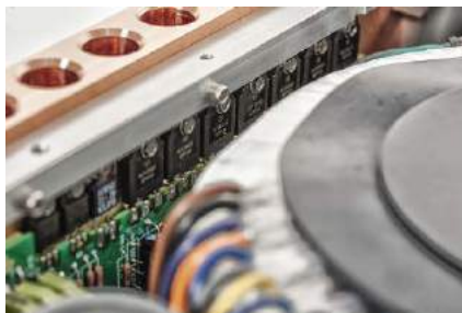
Tranzystory wyjściowe przykręcono bezpośrednio do miedzianych radiatorów.
