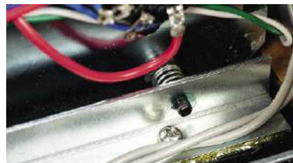
Główną płytę „podwieszono” na sprężynowych tłumikach drgań.
