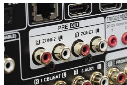
AVC-A1H obsługuje dodatkowo dwie zdalne strefy. A nawet trzy, ale do niej wysłamy już tylko sygnały audio z wyjść RCA lub (zmieniając ich rolę) jednej z dwóch końcówek mocy.
