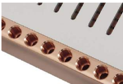
Główne radiatory wykonano z miedzianych bloków, pionowe otwory o zmiennych średnicach wspomagają przepływ powietrza zasysanego spod dolnej ścianki.
