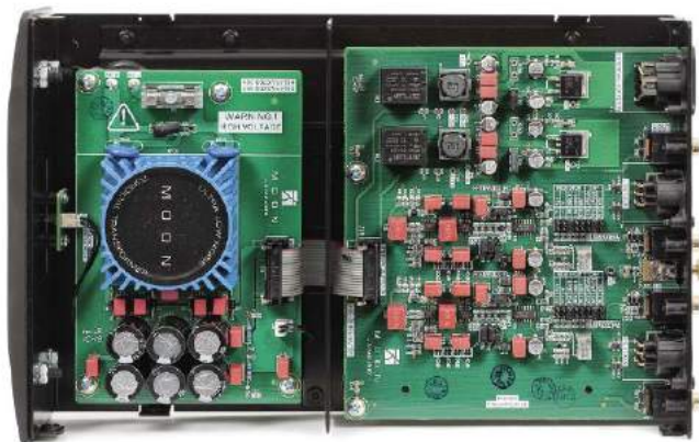
Wnętrze podzielono na dwie sekcje; w przedniej umieszczono (niemal) cały zasilacz, z tyłu komplet obwodów audio..
