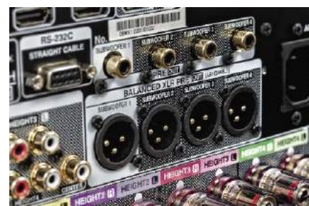
Wyjścia XLR dla subwooferów – aż cztery! wydają się ekstrawagancją, ale mogą okazać się bardzo pożyteczne przy dłuższych połączeniach.
