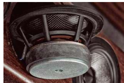
Układy magnetyczne obydwu mają taką samą wielkość (średnica 10 cm), ich siła jest ważna zwłaszcza jeśli chodzi o opanowanie dobrej odpowiedzi impulsowej przez niskotonowe w bas-refleksie.
