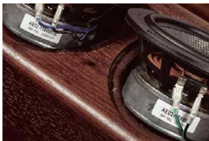
Głośniki średniotonowe i niskotonowe różnią się od siebie nie tylko impedancją, ale też długością cewek drgających.
