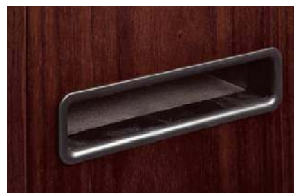
Kształt wylotu nie ma wielkiego wpływu na działanie systemu rezonansowego – o dostrojeniu decydują jego powierzchnia, długość tunelu i objętość komory.
