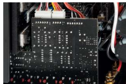
Płytkę przedwzmacniacza została wykrojona, aby nie utrudniać odprowadzania ciepła z końcówek mocy.
