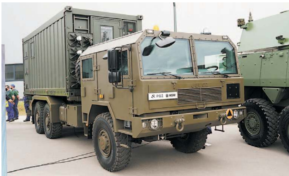
Artyleryjskie Wozy Remontu Uzbrojenia są oparte na samochodzie ciężarowym Jelcz P662D.35 z czteroosobową opancerzoną kabiną Jelcz 144. Zostały wyposażone w kontener z niezbędnym sprzętem do prowadzenia przeglądów i napraw oraz magazyn części zamiennych, służą do wykonywania diagnostyki oraz napraw sprzętu wojskowego w warunkach polowych
