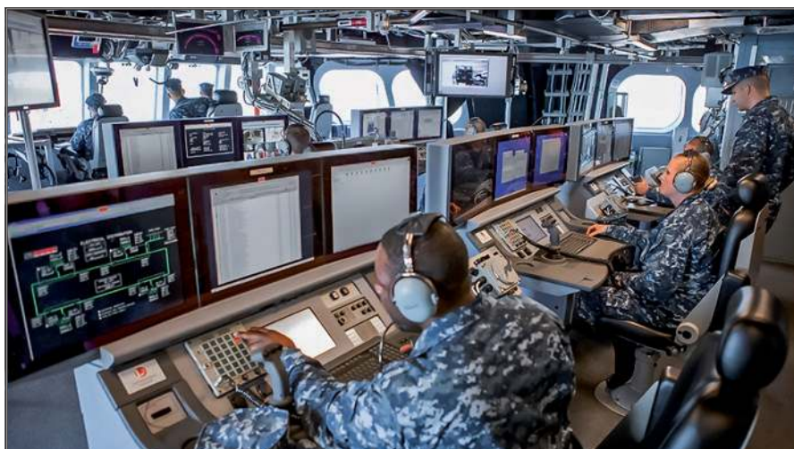
Bojowe centrum informacji na okrętach serii LCS-2 ulokowane jest wraz z głównym stanowiskiem dowodzenia w nadbudówce dziobowej i odseparowane jest od niego jedynie przesuwaną zasłonką.
