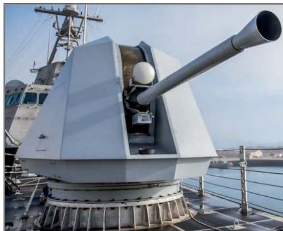
Uniwersalna armata morska kal. 57 mm L/70 Mk 110 Mod. 0 Bofors/BAE Systems na pokładzie USS Kansas City .
