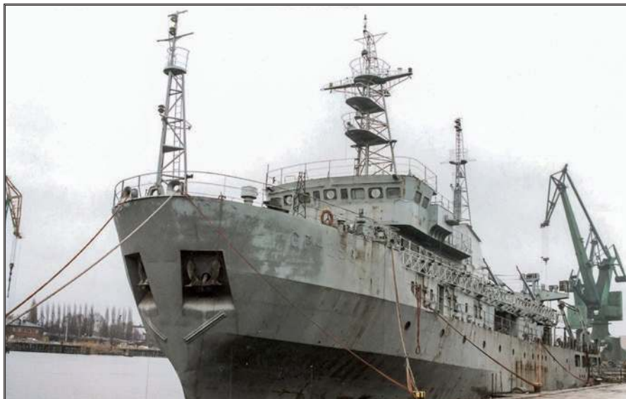
Już nie pływająca stacja demagnetyzacyjna, ale jeszcze nie okręt wsparcia logistycznego. Kadłub jednostki przy nabrzeżu Stoczni Północnej w Gdańsku w trakcie prac wyposażeniowych w 2001 r. w 2001 r. Na dziobie widoczne jest jeszcze pierwotne radzieckie oznaczenie „CP-235” (litery w alfabecie rosyjskim).
