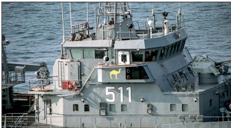
Nadbudówka jednostki z dobrze widocznym numerem taktycznym oraz namalowanym przez załogę wielbłądem – dowodem pobytu na misji w Zatoce Perskiej. Po bokach armaty widoczne wyrzutnie celów pozornych systemu Jastrząb 2 , natomiast za bryłą GSD na burcie widoczna podstawa do montowania czterech przenośnych wyrzutni rakiet przeciwlotniczych Strzała-2M .
