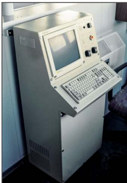
Konsola operatora wyrzutni celów pozornych Jastrząb 2.
