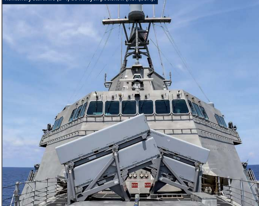
Kontenery startowe (2x4) do nowych pocisków (NSM/JSM).
