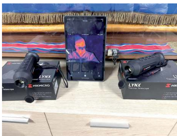
Termowizory dają możliwość szybszego odnalezienia osób zaginionych w nocy przez wykrywanie emitowania przez tę osobę promieniowania cieplnego z odległości nawet ok. 1 kilometra (fot. OSP Krzywda)
