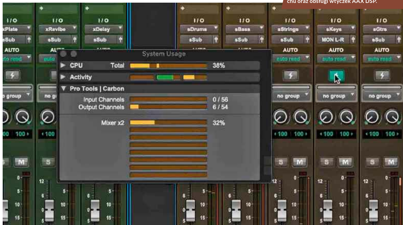
Na każdym torze sygnałowym programu Pro Tools | Carbon znajduje się przycisk z błyskawicą, którym uruchamiamy obsługę DSP dla danego toru w zakresie bezlatencyjnego odsłuchu oraz obsługi wtyczek AAX DSP.
