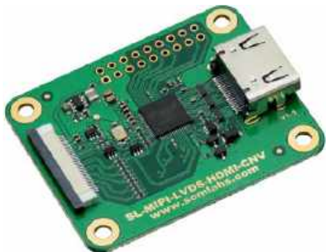
Fotografia 4. Wygląd konwertera MIPI-DSI na HDMI/LVDS firmy SoMLabs
