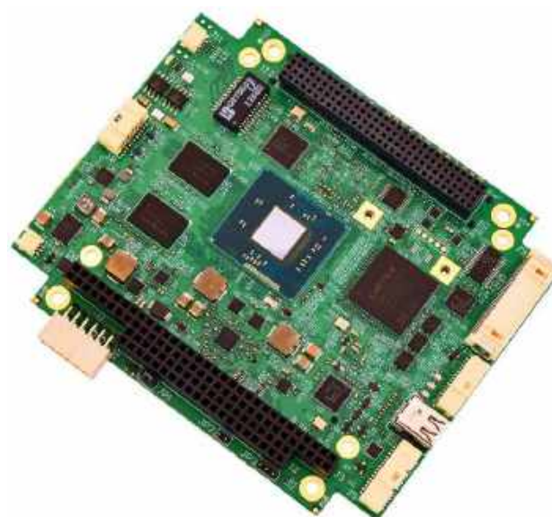
Fotografia 3. Komputer jednopłytkowy w standardzie PC/104, PC/104 Plus
