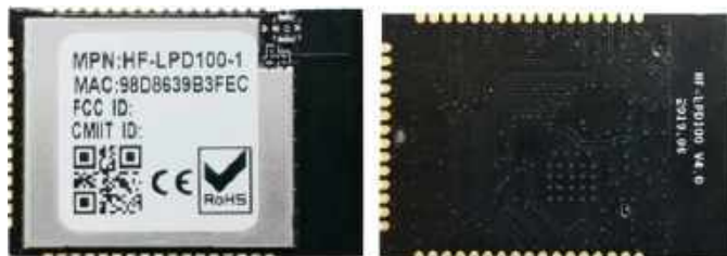
Rysunek 2. Dwuzakresowy moduł typu HF-LPD100
