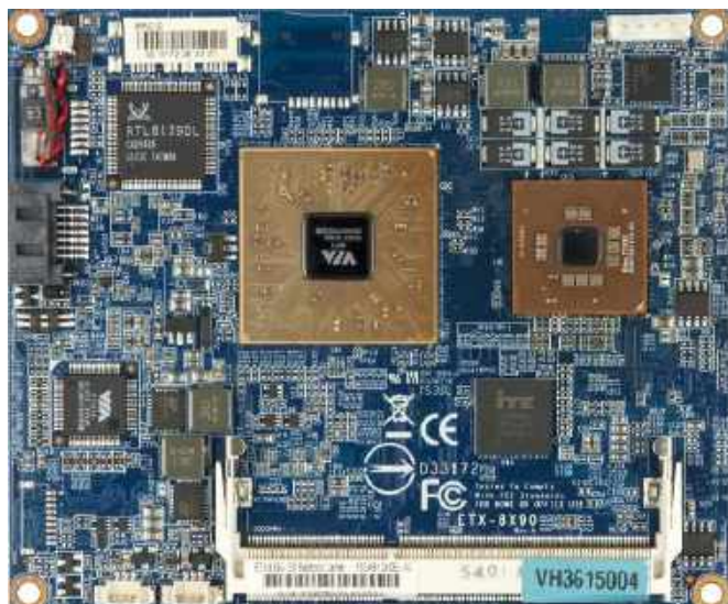
Fotografia 8. Komputer jednopłytkowy w standardzie ETX
