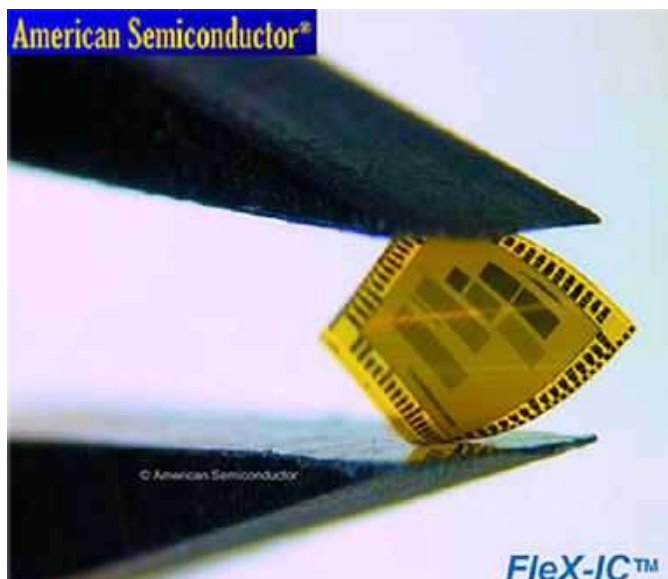
Fotografia 1. Elastyczny układ scalony krzemowo-polimerowy [6]
