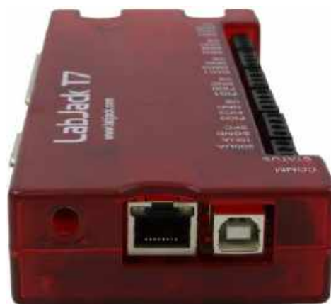
Fotografia 1. Złącza komunikacyjne modułu Labjack T7
