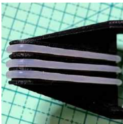
Fotografia 3. Montaż łap robota kota
