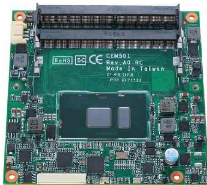
Fotografia 6. Komputer jednopłytkowy w standardzie ESM Express
