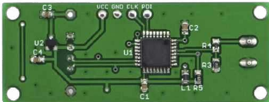
Fotografia 1. Zmontowana płytkę, widok od strony BOTTOM
