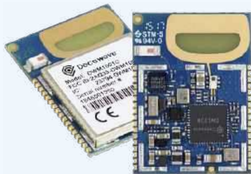
Rysunek 24. Moduł DWM1001C firmy Decawave [17]
