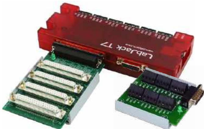
Fotografia 2. Rozbudowę systemu ułatwiają moduły rozszerzające
