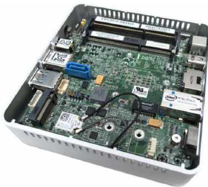
Fotografia 9. Komputer jednopłytkowy w standardzie NUC
