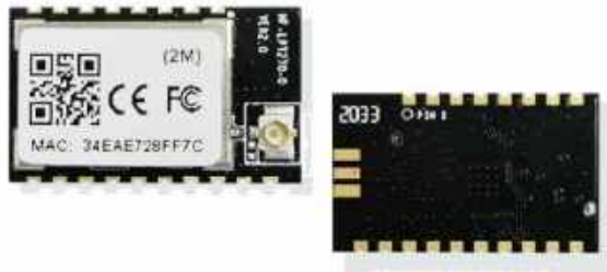
Rysunek 6. Moduł typu HF-LPT270
