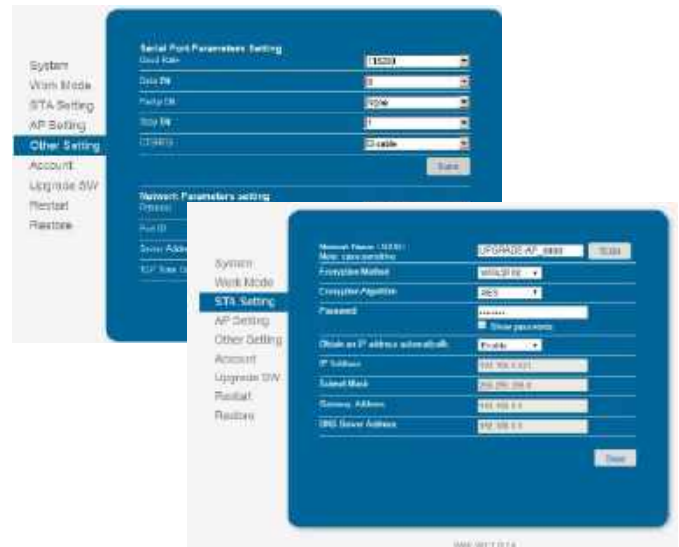
Rysunek 7. Wygląd interfejsu do konfiguracji modułu
