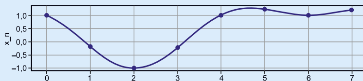
Rysunek 1. Ciągły sygnał wejściowy z zaznaczonymi miejscami próbkowania
