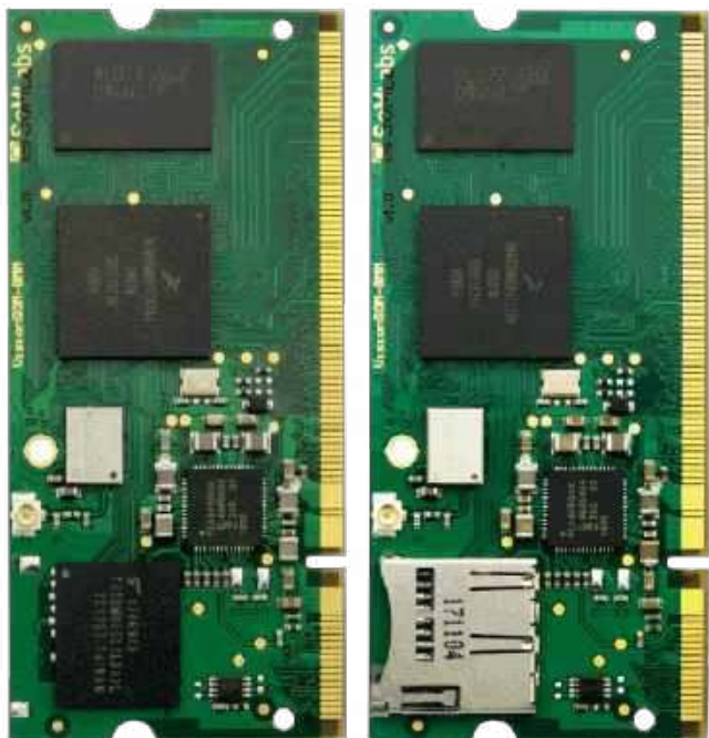
Fotografia 13. Komputer jednoplótkowy na złączu SODIMM
