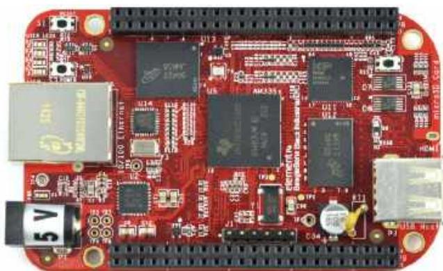
Fotografia 17. Mikrokontroler Sitara AM335x firmy Texas Instruments
