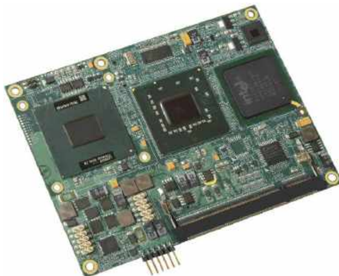
Fotografia 7. Komputer jednopłytkowy w standardzie XTX
