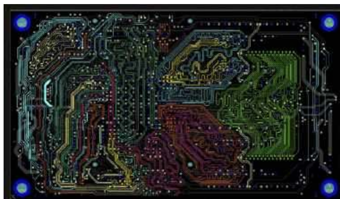
Fotografia 1. Schemat płytki PCB z interfejsem DDR dla układu SOC
