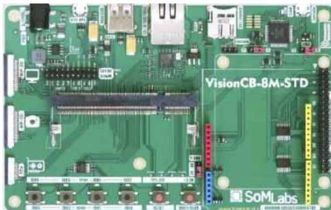
Fotografia 16. Płyta przeznaczona do współpracy z modulem SLS23
