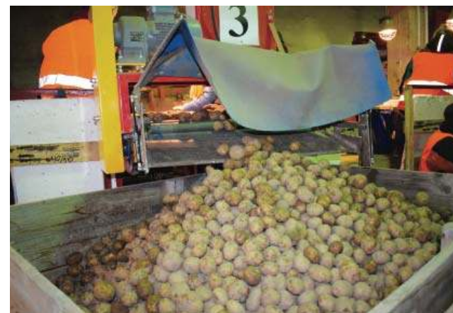
Partie ziemniaków przeznaczone do sortowania trzeba najpierw podgrzać, ponieważ im ziemniaki zimniejsze, tym bardziej wrażliwe na uszkodzenia
