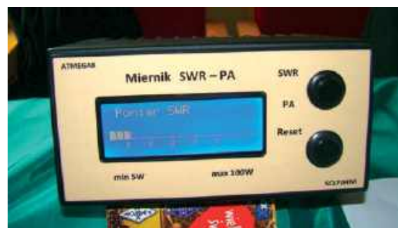
Mikroprocesorowy miernik do pomiaru SWR i mocy wyjściowej wzmacniacza wg SQ7JHM
