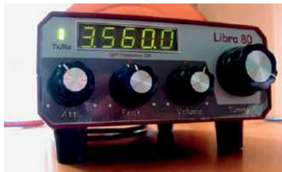
Transceiver telegraficzny Libra wg SP5DDJ
