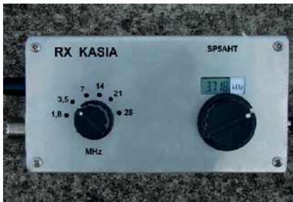
Odbiornik nasłuchowy Kasia wg SP5AHT (praca pozakonkursowa)
