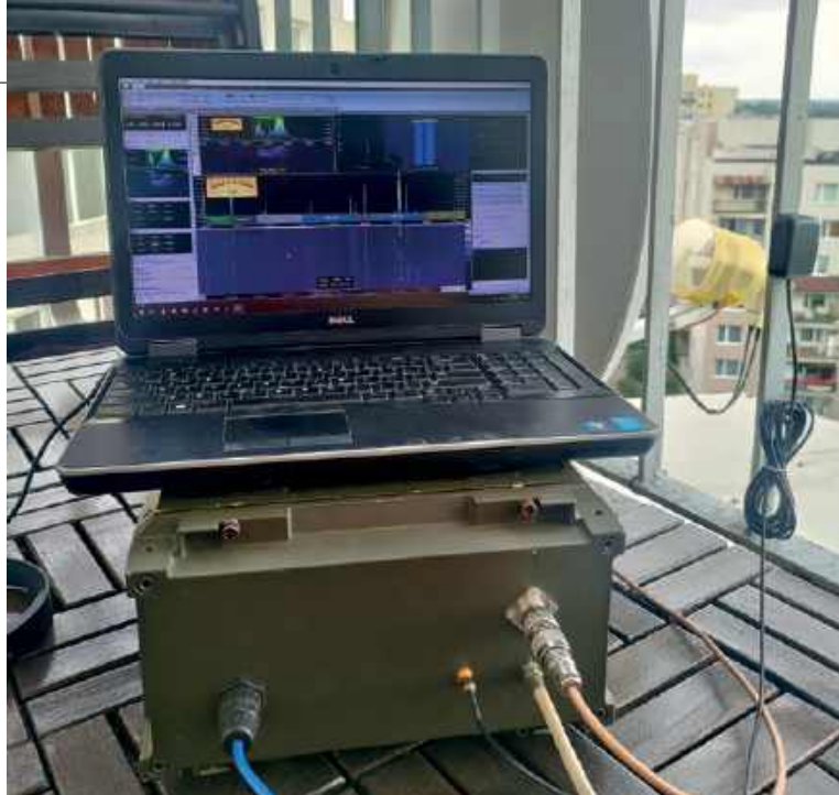
Stacja bazowa QO-100 na bazie Pluto wg SQ5NRY
