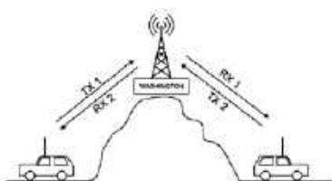
Rys. 2. Zasada działania automatycznego przekaźnika
