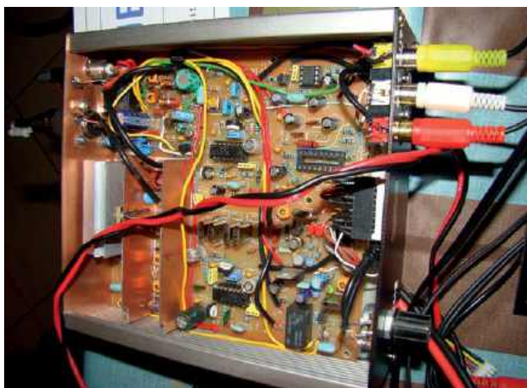
TRX Kacper PSK na pasmo 40 m zmodyfikowany przez Marka SQ7HJB
