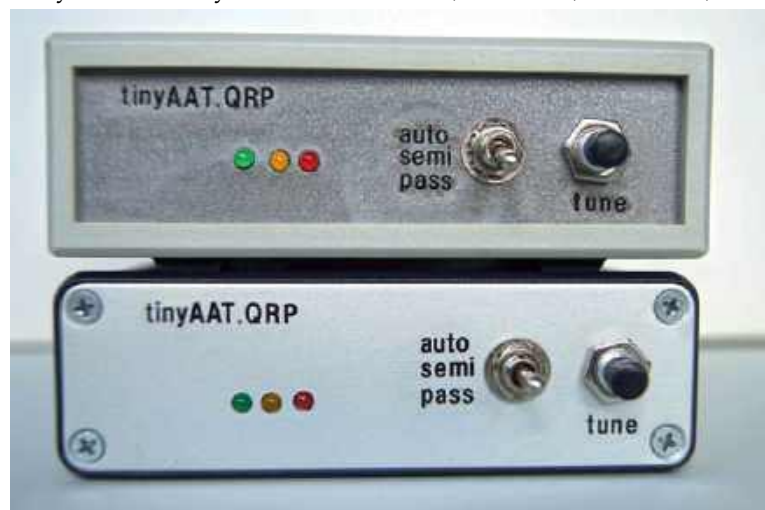
Automatyczny tuner antenowy QRP wg 3Z6AEF
