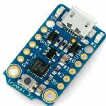
Miniaturowy moduł z mikrokontrolerem AVR Attiny85 „Trinket”
