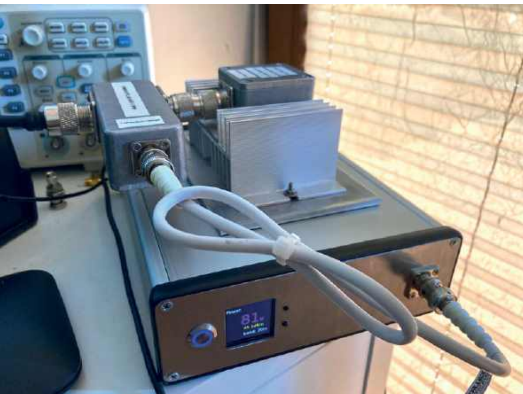
Stanowisko do pomiaru mocy RF wg SP5GW
