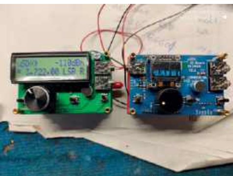
Transceiver QCX SSB wykonany przez SP6LTP
