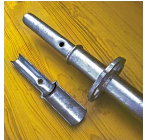
Fot. 6. Wygląd stojaka produkcji PIONART wraz z jego przecięciem, uwidaczniającym przetłoczenie w formie czopu
