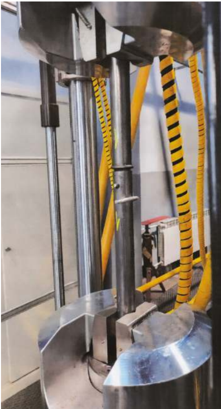
Fot. 2. Przykładowe połączenie elementów rusztowania w maszynie wytrzymałościowej. Zdjęcie zostało wykonane podczas badań w Centrum Spawalnictwa Górnośląskiego Instytutu Technologicznego Łukasiewicz 1
