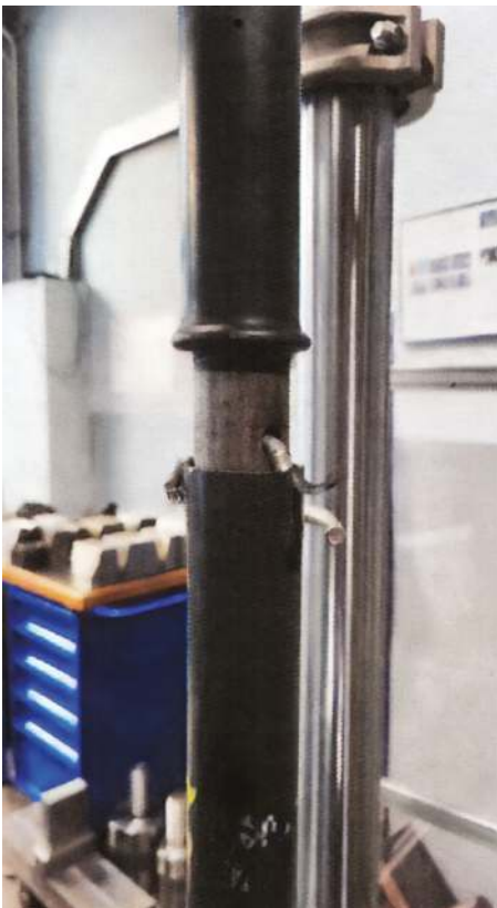
Fot. 3. Widok połączenia po wykonanej próbie wytrzymałościowej. Zdjęcie zostało wykonane podczas badań w Centrum Spawalnictwa Górnośląskiego Instytutu Technologicznego Łukasiewicz 1
