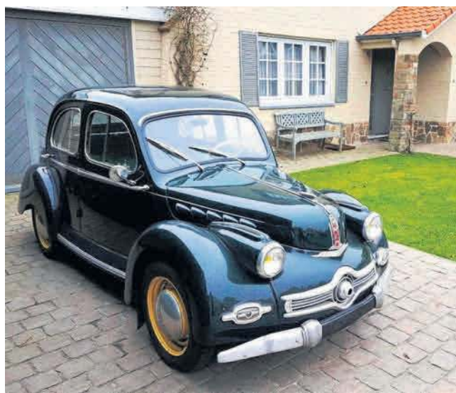
Pierwszy powojenny model Panharda, Dyna X z nadwoziem z aluminium konstrukcji inżyniera Jean-Alberta Grégoire, otrzymał we Francji – zapewne za sprawą niegustownych ozdóbek – przezwisko Ludwik XV
