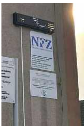
Tablica na bieżąco pokazuje podstawowe parametry, takie jak poziom pyłów PM2.5 i PM10, temperaturę, wilgotność oraz ciśnienie
