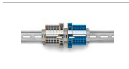
Za pomocą mostka redukcyjnego można np. w prosty sposób połączyć złączki 6 mm 2 ze złączkami 16 mm 2
