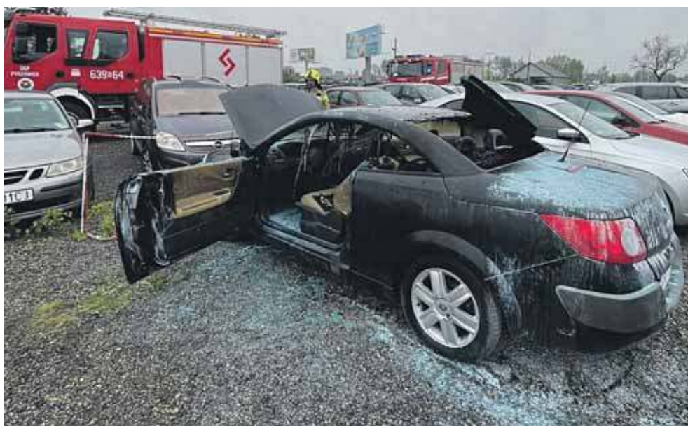
Prawdopodobną przyczyną pożaru samochodu było zwarcie instalacji elektrycznej
