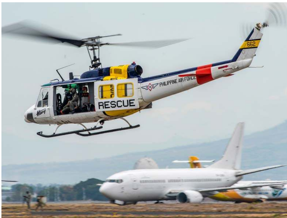
Jeden z dwóch egzemplarzy UH-1H-II Huey II , czyli zmodernizowanych UH-1H. Te maszyny, tak jak Belle 205A-1, są wykorzystywane do poszukiwania i ratownictwa oraz ewakuacji medycznej.
