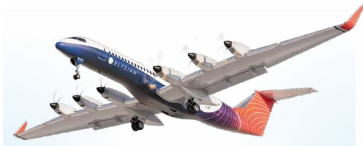
Zmodyfikowany projekt samolotu komunikacji regionalnej EX-9 zakłada redukcję liczby silników elektrycznych z pierwotnie planowanych ośmiu do sześciu.
