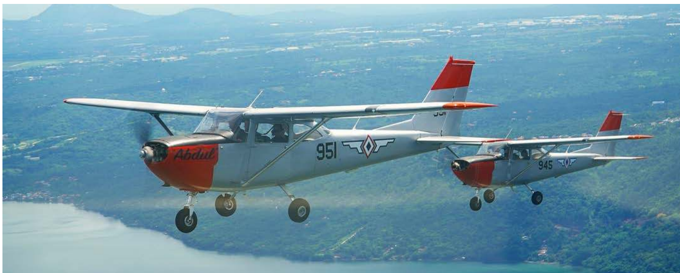
Do wstępnego szkolenia w pilotażu oraz zadań obserwacyjnych i łącznikowych wciąż służą ponad 50-letnie samoloty T-41 Mescalero . Większość T-41D (na zdjęciu) wycofano już ze służby, ale w 2009 roku otrzymano z Korei Południowej 15 używanych T-41B.
