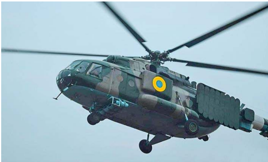
Rzadkie zdjęcie śmigłowca Mi-8MTPB z 456. Brygady Lotnictwa Transportowego SP SZU wyposażonego w system walki radioelektronicznej.
