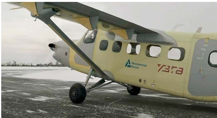
W trzecim prototypie Bajkał zaszły znaczne zmiany konstrukcyjne. Najbardziej widoczne z zewnątrz są nowe drzwi do kabiny pilotów i wzmocnione podwozie główne.
