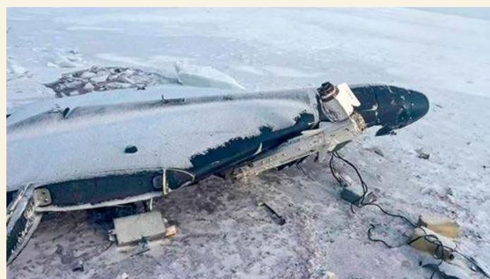
Szczątki rosyjskiego bezałogowca Szahid z bojowym pociskiem powietrze–powietrze R-60. Pocisk jest zamontowany na górze platformy – na zdjęciu zestrzelony aparat leży w pozycji odwróconej na plecy.
