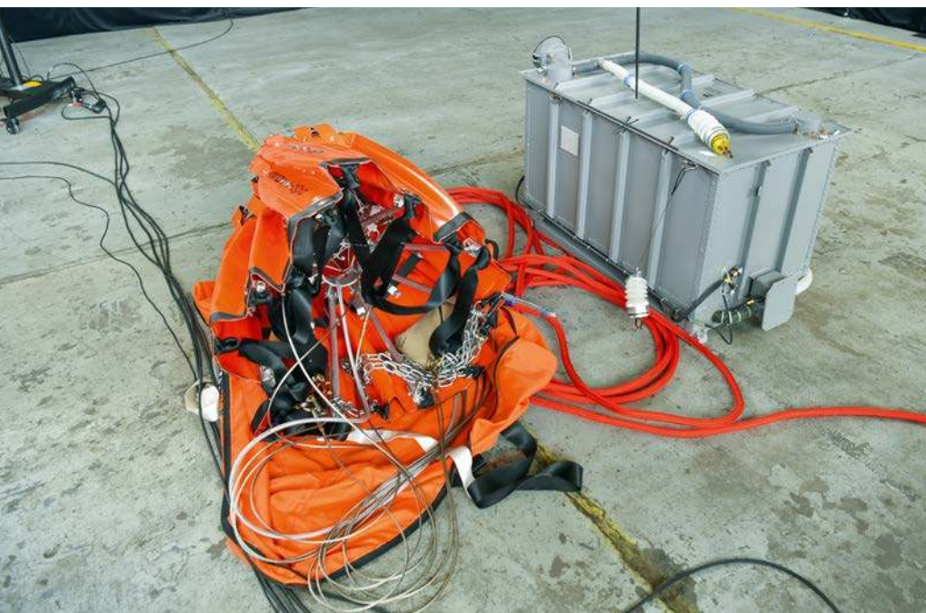
Podwieszany miękki zbiornik gaśniczy typu Bambi Bucket przeznaczony do akcji przeciwpożarowych oraz dodatkowy zbiornik paliwa zwiększający długotrwałość lotu.
