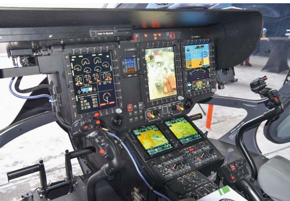
Wnętrze kabiny załogi śmigłowca H145D3 z wielofunkcyjnymi wyświetlaczami.
