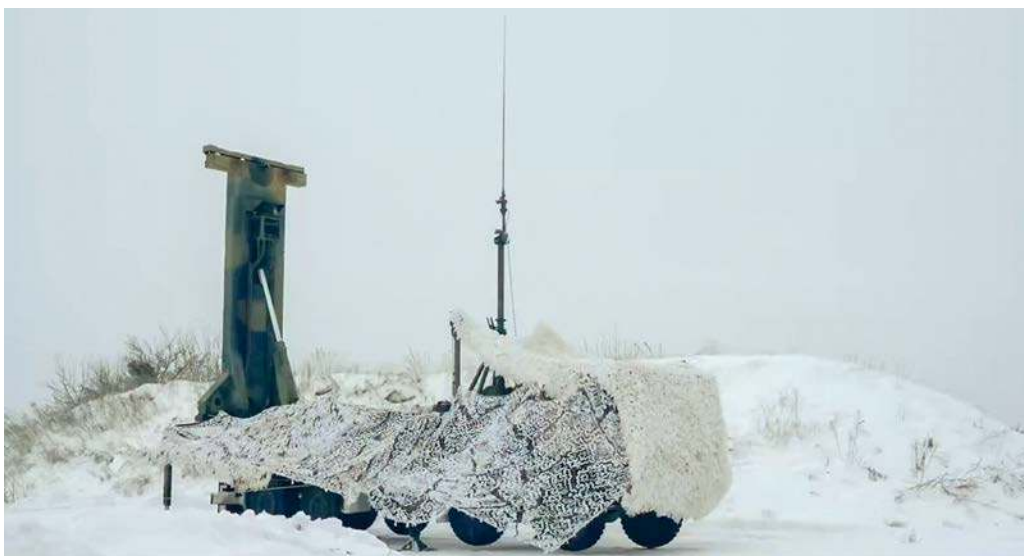
Wyrzutnia francusko-włoskiego systemu plot. SAMP-T, który jest wykorzystywany przez SZU. Zwraca uwagę brak kontenerów z pociskami.
