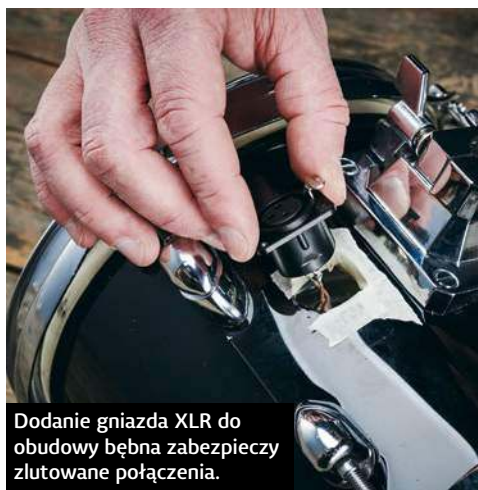
Po zamontowaniu gniazdo powinno przylegać do obudowy bębna.
