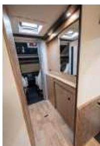
Dzięki osłonięciu szoferki łazienką i szafą w Mooveo TEI-72UH podczas jazdy powinno być ciszej, a straty ciepła zimą mniejsze
