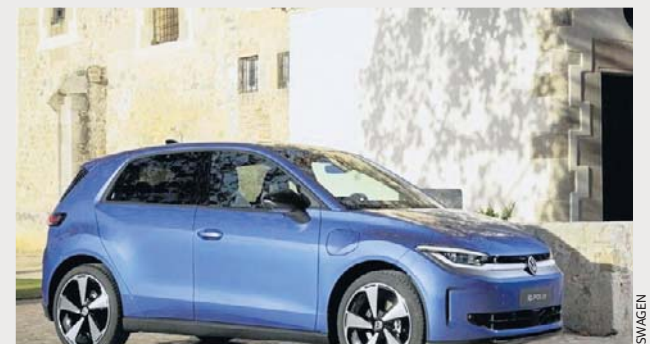
Nowe ID. Polo ma 4 053 mm długości, 1 816 mm szerokości i 1 530 mm wysokości. Rozstaw osi wynosi 2 600 mm.
