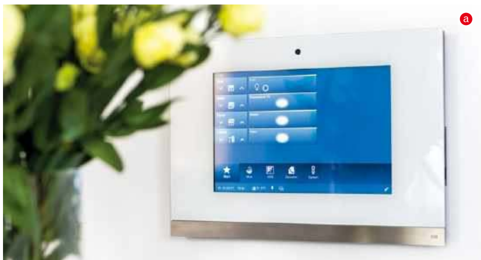
❏ Dwa podstawowe sposoby zarządzania instalacjami domu inteligentnego: przy pomocy panelu sterowania umieszczonego np. na ścianie (a ABB) i smartfona (b SATEL).
