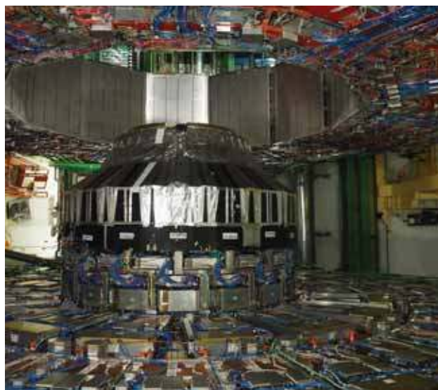
Fot. 10. Detektor CMS zbudowany jest wokół ogromnego magnesu solenoidalnego.
