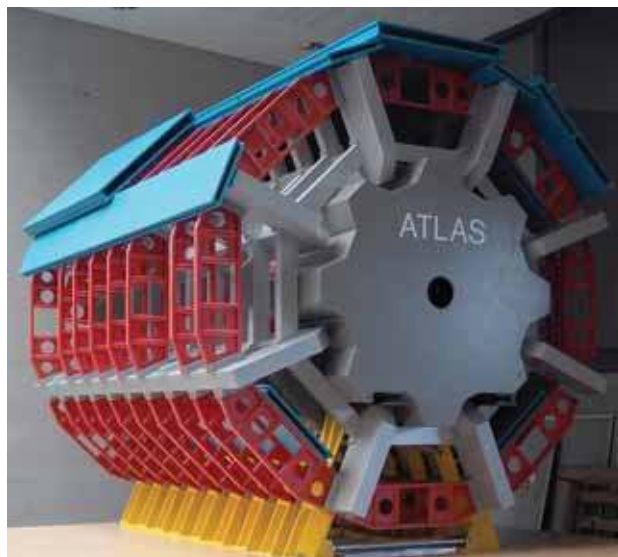
Fot. 9. Model detektora ATLAS, widoczne magnesy toroidalne zakrzywiające tory naładowanych cząstek.
