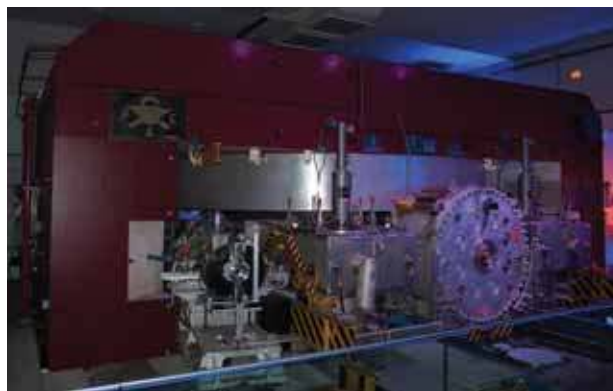
Fot. 1. Synchrociklotron był pierwszym akceleratorem zainstalowanym w CERN. Przyspieszał cząstki do maksymalnej energii 600 MeV, służąc eksperymentom naukowym przez 33 lata.
