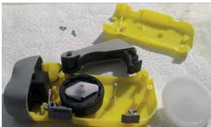
Fotografia 3. A – Latarka z dwoma wyświetlaczami z wykorzystaniem idei dynama; B – wnętrze tak wykonanej latarki.
