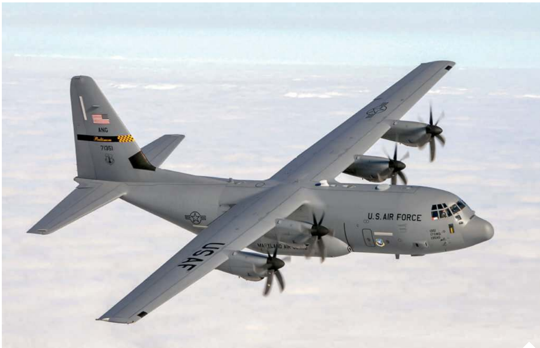
Samolot Lockheed C-130J Super Hercules jest w stanie zabrać ze sobą 15-tonowy ładunek na odległość ponad 3300 km | fot. Wikipedia/d
