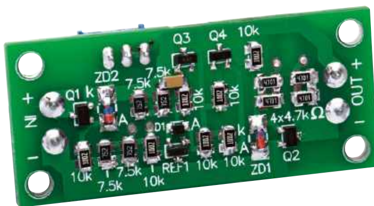
Powiększone zdjęcie dolnej strony regulowanej wersji SMD zabezpieczenia zasilania DC. W porównaniu z pozostałymi wersjami w tej zastosowano elementy zamontowane po obu stronach płytki drukowanej
