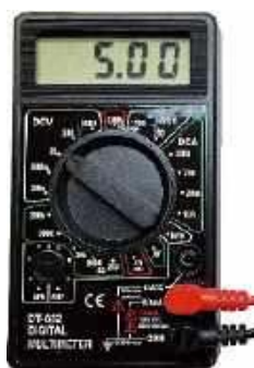
Rysunek 16. Pomiar napięcia zasilania na wyprowadzeniach podstawki pod układ US2. Pamiętaj, aby przed pomiarem podłączyć baterię 9 V do złączki oraz ustawić przełącznik SW1 w pozycji ON
