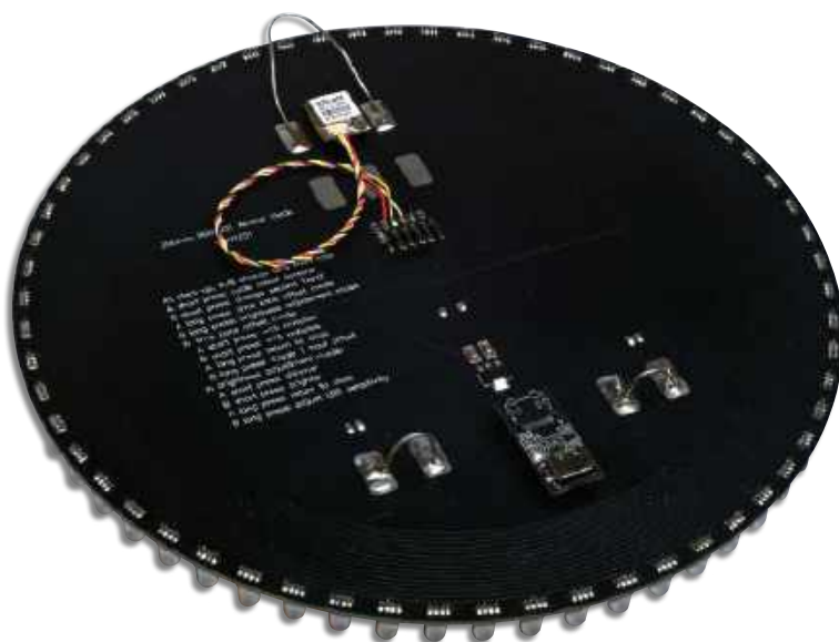
Do tych pól lutowniczych na dolnej stronie płytki drukowanej zegara przylutowaliśmy grubą drut służący do zawieszenia zegara na ścianie
