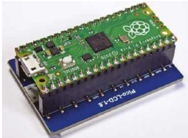
Fotografia 2. Wyświetlacz LCD o przekątnej 1,8 cala można łatwo podłączyć od spodu modułu RPi Pico
