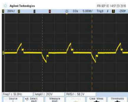
Oscylogram 3. Tak powinno się ściemniać lampę LED. W tym przypadku jest ona sterowana przez ściemniacz obcinający zbocze opadające, ustawiony na niskim poziomie jasności. Tutaj napięcie na lampie płynnie narasta od zera do nieco poniżej 200 V, po czym tranzystor wyłącza zasilanie lampy do momentu rozpoczęcia kolejnego półcyklu. Lampa odpowiada na zmniejszone wypełnienie cyklu pracy (niższe napięcie szczytowe) zmniejszoną jasnością.
