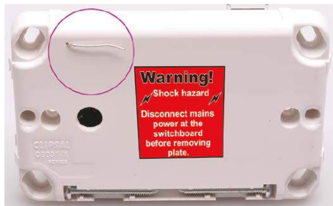
Te trzy zdjęcia pokazują lokalizację i montaż drutu łączącego obwód PCB z zewnętrzną aluminiową płytką dotykową. Przechodzi on przez otwórki w płytce nośnej i w obudowie Clipsal oraz styka się z aluminiową płytką dotykową po jej zatrzasknięciu w obudowie. Uwaga – nie pokazano soczewki Fresnela!
