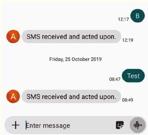
Rysunek 9. Ponieważ Zdalna Stacja Monitoringu 4G jest zasilana okresowo, może nie odpowiadać na polecenia SMS natychmiast. Dwuminutowe opóźnienie pokazane tutaj wystąpiło podczas testów, kiedy mieliśmy nakładkę ustawioną na wyłączenie zasilania na około jedną minutę. Reakcja może być zmieniona poprzez edycję kodu Arduino.
