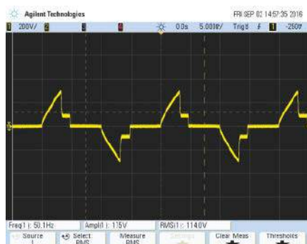
Oscylogram 4. Ta sama lampa LED zasilana z tego samego ściemniacza, ale z nieco zwiększonym poziomem jasności. Widoczny schodek to prawdopodobnie rozładowywanie kondensatorów w zasilaczu impulsowym lampy po wyłączeniu MOSFET-ów w ściemniaczu, z niewielkim zwrotnym impulsem napięciowym przez mostek prostowniczy do układu zasilania.
