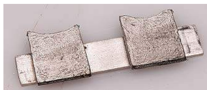
Wykonany przez nas element maskujący zakrywający wycięcia (jak widać obok). Rysunek 4 (poniżej) pokazuje wymiary.
